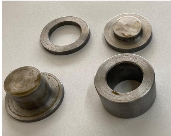
Figura 9 - Conjunto de molde metálico de 27 mm utilizado na prensagem das pastilhas cerâmicas.
