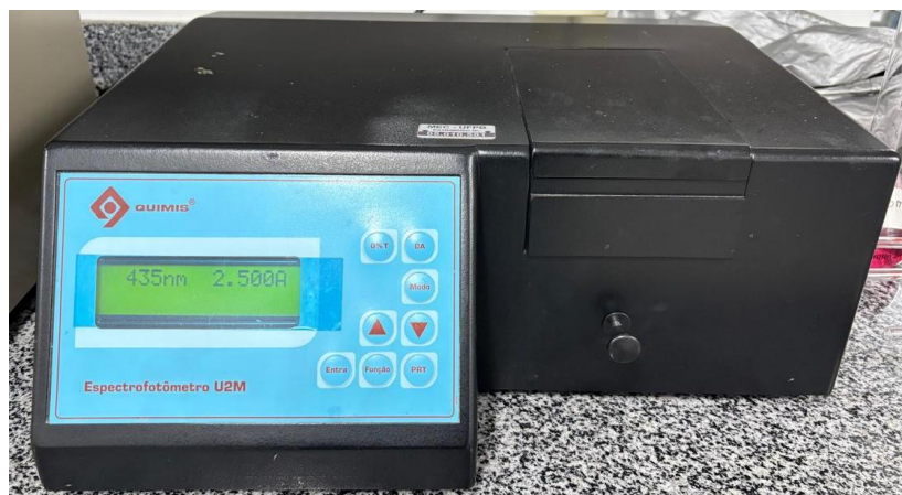
Figura 14 – Espectrofotômetro modelo U2M (Quimis) utilizado nas análises.
