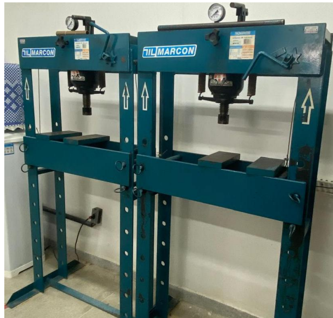
Figura 10 - Prensa hidráulica MARCON-MPH-30 utilizada na compactação das amostras para obtenção das pastilhas cerâmicas.
