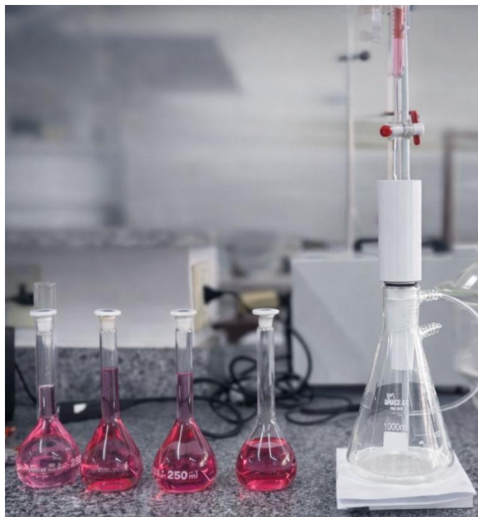
Figura 13 – Sistema de filtração utilizado na avaliação do desempenho das membranas cerâmicas.
