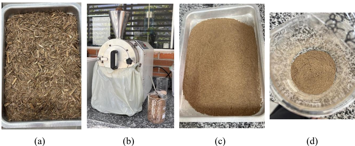
Figura 7 – Etapas do processamento do bagaço de cana-de-açúcar: (a) bagaço in natura ; (b) moagem em moinho de facas; (c) material moído; (d) bagaço peneirado para uso na preparação das amostras.
