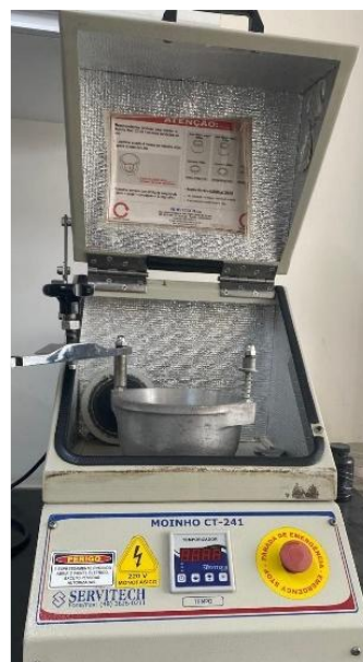
Figura 8 - Moinho de bolas Servitech CT-241 utilizado na homogeneização da mistura das matérias-primas para a preparação das membranas cerâmicas.
