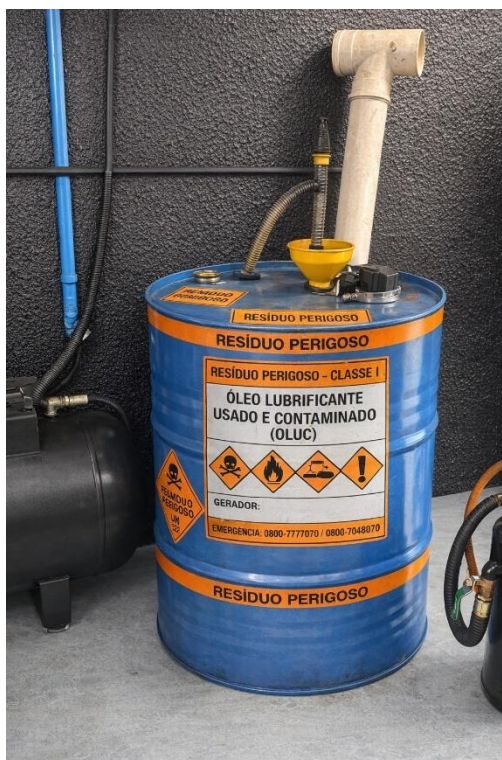
Figura 11 - Modelo ilustrativo de identificação de tambor para armazenamento de óleo lubrificante usado
