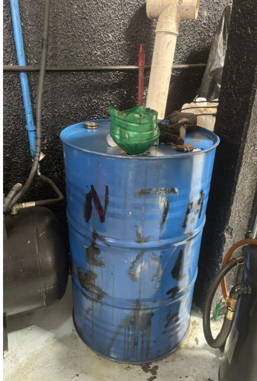
Figura 9 - Tambor utilizado para armazenamento temporário de óleo lubrificante usado na Oficina 4
