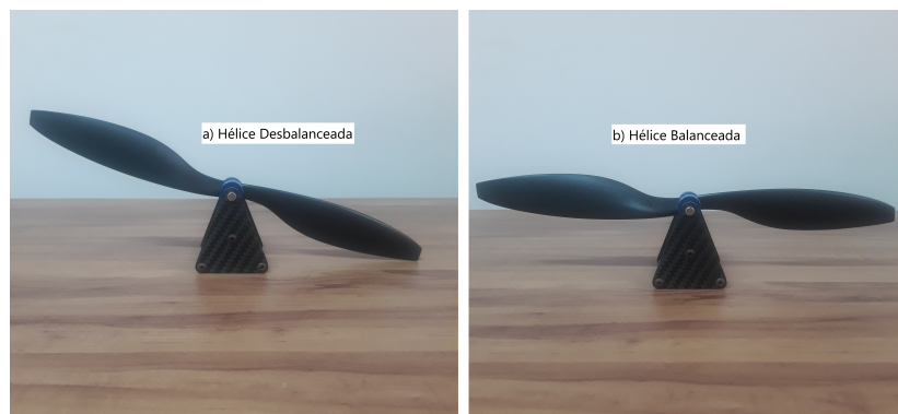
Figura 4.5: Hélice desbalanceada e hélice balanceada.
