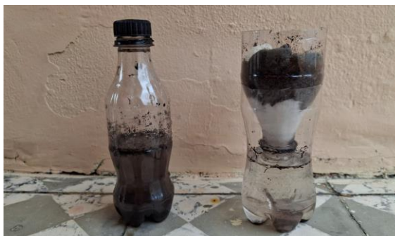
Figura 2 – Modelo demonstrativo de filtro caseiro utilizado no primeiro encontro da Sequência Didática Interativa (SDI).
