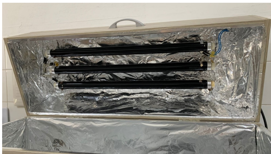
Figura 9 – Lâmpadas UVA na parte interna da câmara de radiação
