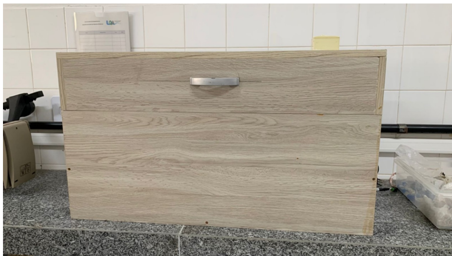
Figura 8 – Câmara de radiação em MDF
