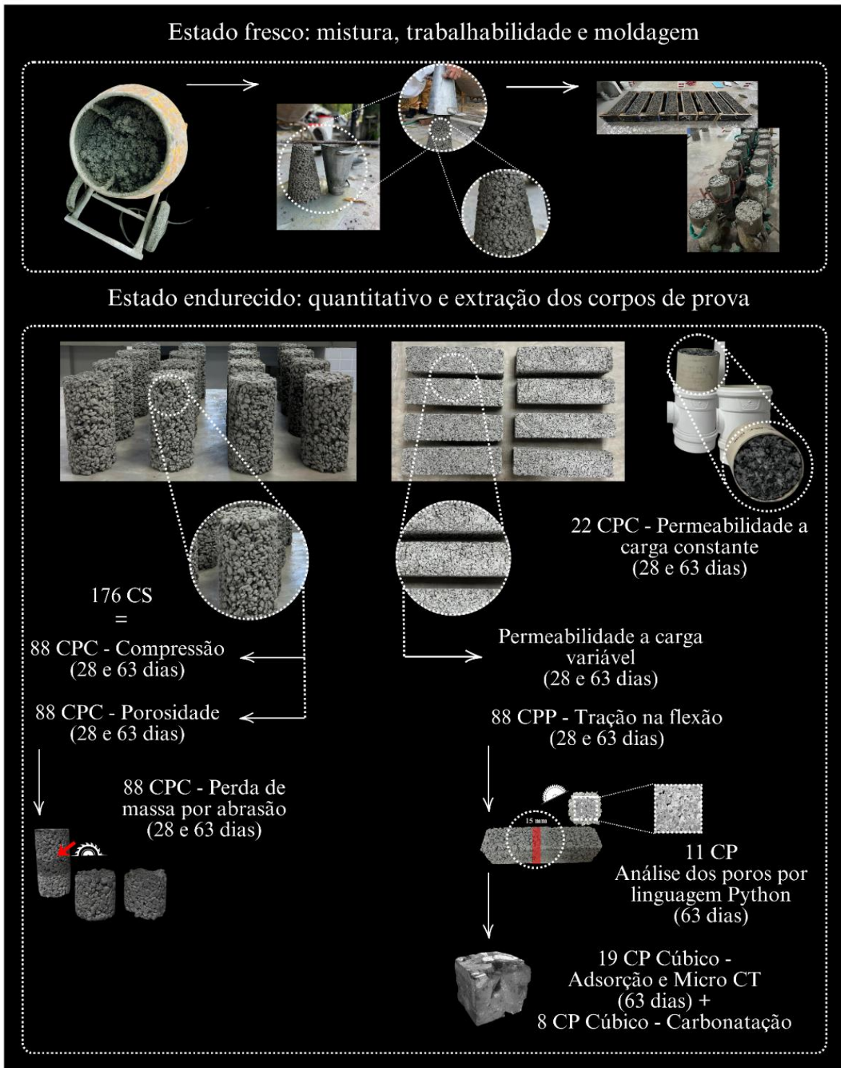
Figura 3.11 – Procedimento de mistura, avaliação da trabalhabilidade, moldagem e extração dos corpos de prova das misturas de concreto permeável estudadas
