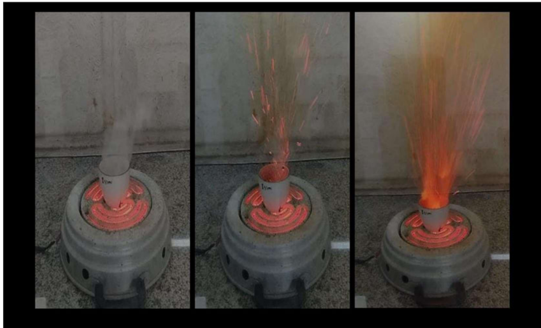
Figura 7: Registros de reação de combustão (a) liberação de gases durante o processo (b) início da explosão (c) durante a explosão
