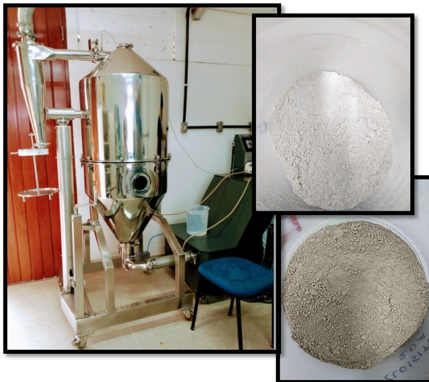
Figura 6: Equipamento Spray Dryer e argilas caulim (branca) e bentonita (verde) purificadas.
