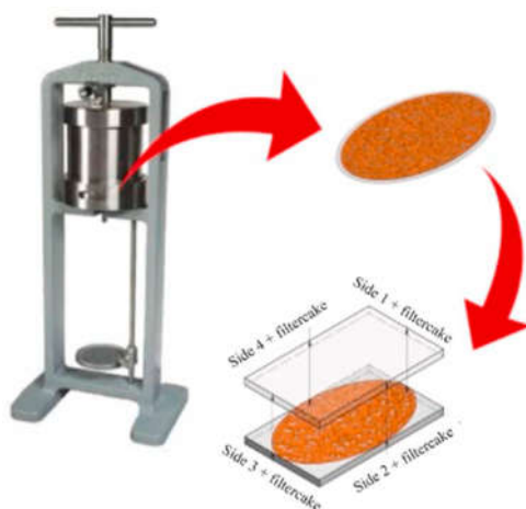
Figura 4.4 - Representação esquemática da medição da espessura da torta de filtração
