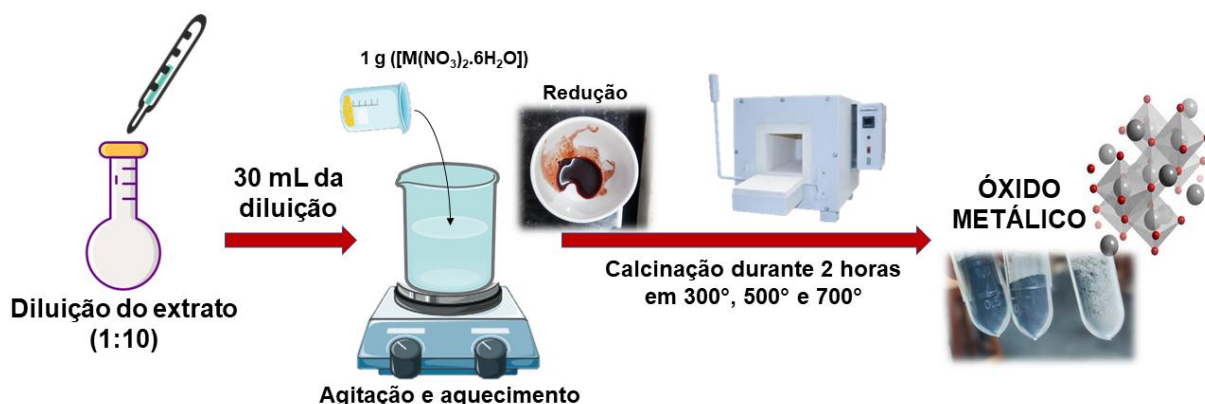
Figura 3.2 - Procedimento experimental de síntese dos óxidos metálicos.
