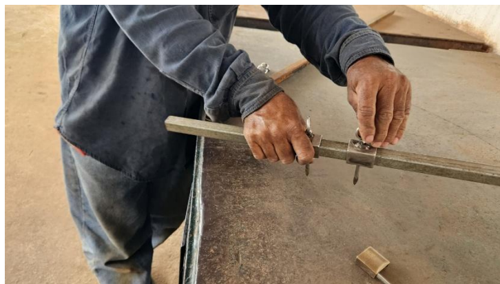
Figura 1 – Gramil modificado para uso como compasso de grandes dimensões.
