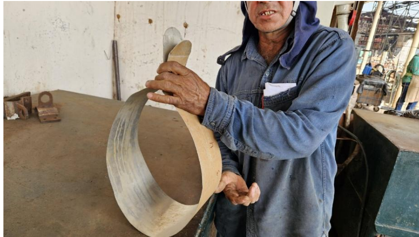
Figura 2 – Piaba utilizada como molde (gabarito) para conformação de peças.
