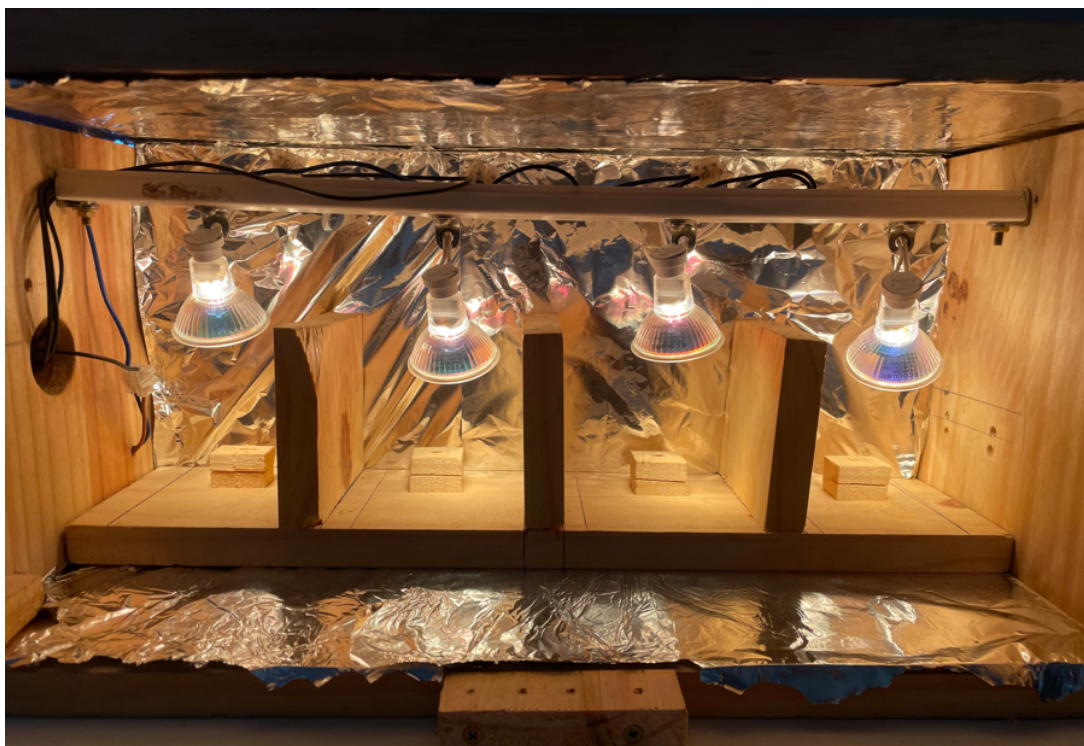
Figura 17: Vista interna do sistema de iluminação do protótipo.
