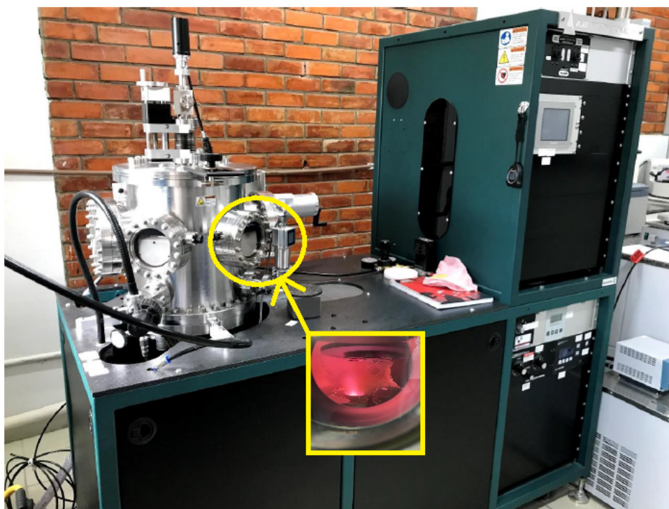
Figura 13: Equipamento de um Sistema Sputtering .
