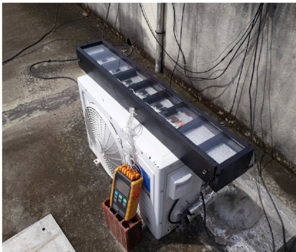
Figura 11: Bancada experimental em madeira para testes de campo.
