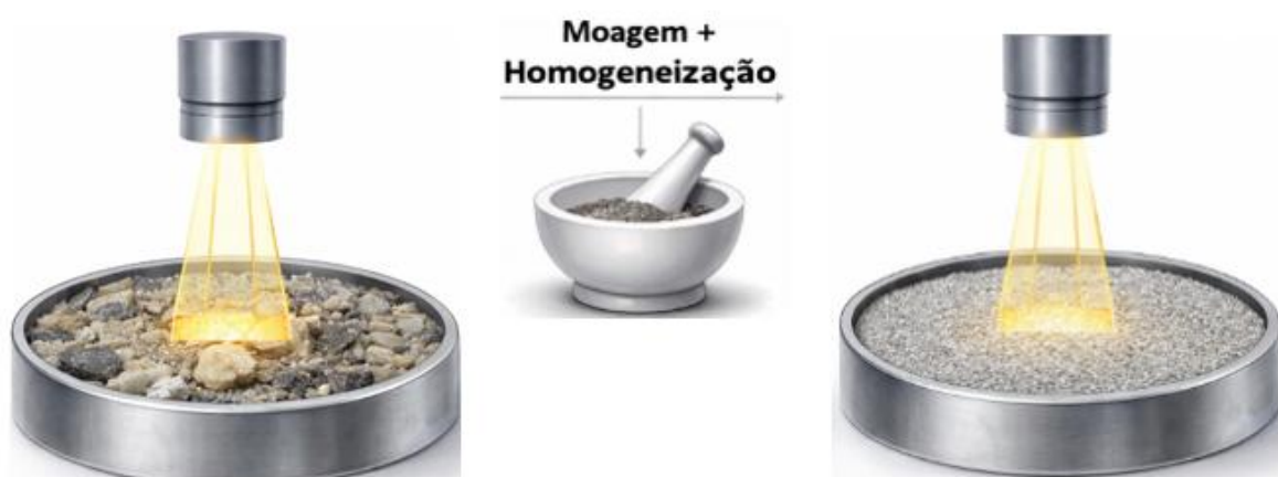
Figura 11. Cominuição da amostra garantindo uma distribuição estatística das partículas.
