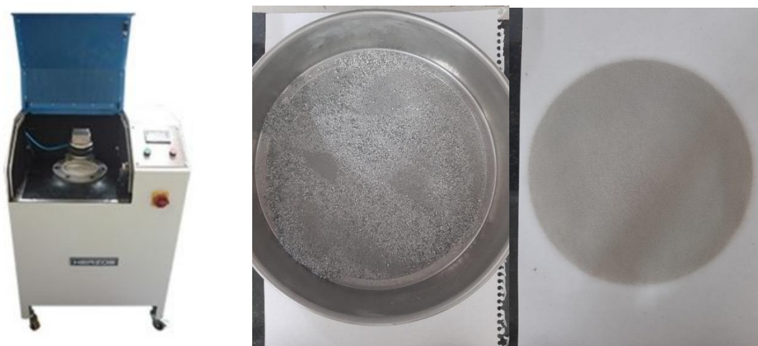
Figura 25. Etapa de moagem e peneiramento da amostra.
