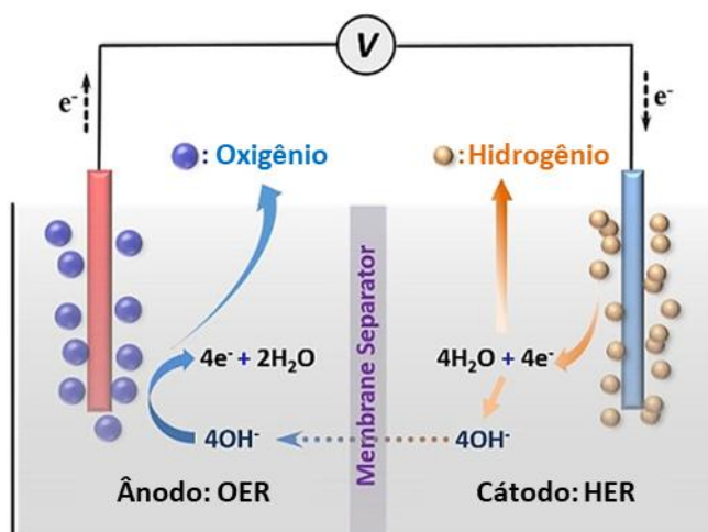
Figura 4 - Esquema do processo de eletrólise da água em meio alcalino.
