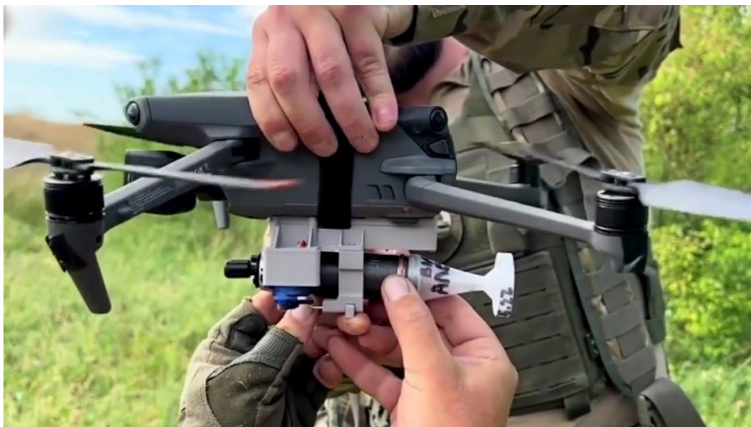
FIGURA 10 – Granada VOG-17 modificada para ser lançada a partir de um drone
