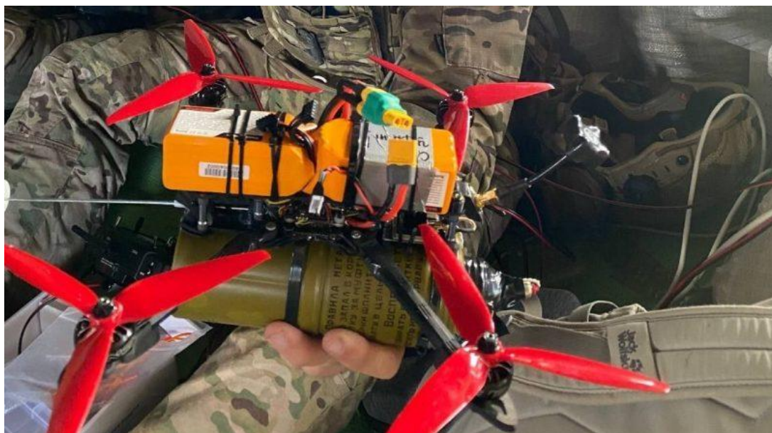
FIGURA 11 – Granada RKG-3 modificada para ser lançada a partir de um drone
