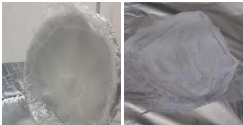
Figura 17. Fibras produzidas via SBS com Nylon 66
