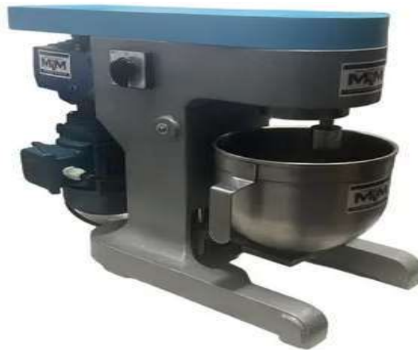
Figura 19. Argamassadeira para mistura do cimento com fibras, areia e água
