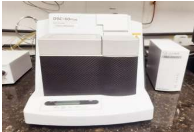
Figura 24. Equipamento de ensaio do DSC- LAMAB-UFPB
