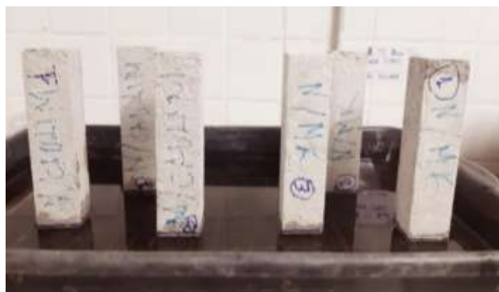
Figura 25. Corpos de prova prismáticos no Ensaio NBR 15259:2005
