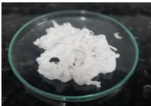
Figura 18. Fibras produzidas via SBS com Nylon 66/Caulim
