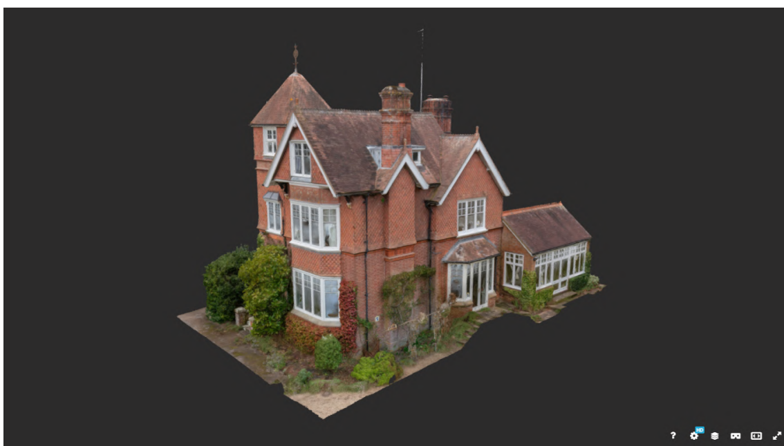
Figura 13: Modelo digital de edificação criado com ajuda de fotogrametria
