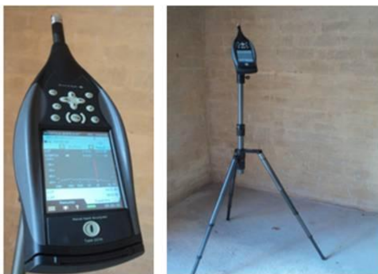
Figura 40 - Analisador Acústico tipo 2270 da marca Brüel & Kjær Fonte: Acervo pessoal.
