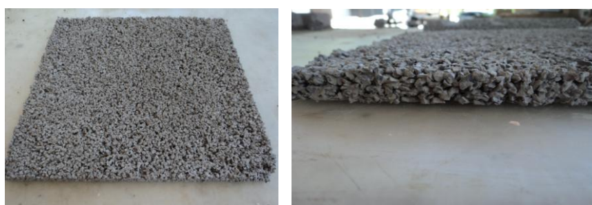
Figura 30 - Placa EVA_ar0 - base de superfície plana. Fonte: Acervo pessoal.
