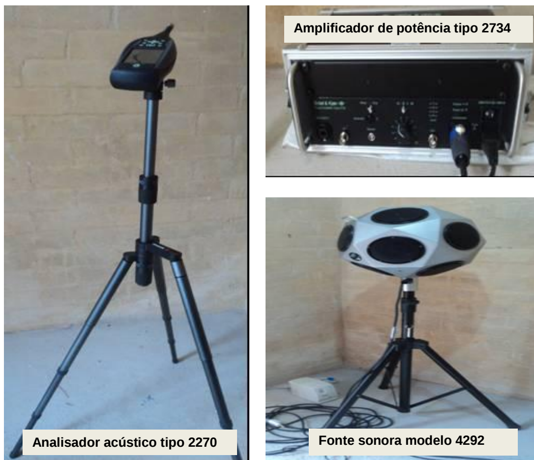
Figura 42 - Equipamentos da marca Brüel & Kjær utilizados no ensaio do Tempo de Reverberação
