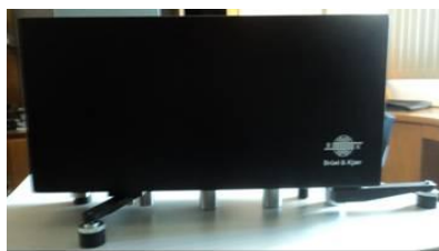
Figura 38 – Máquina de impacto tipo 3207 da marca Bruel Kja&r Fonte: Acervo pessoal.
