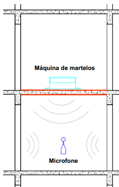
Figura 07 – Esquema da disposição das câmaras de emissão e recepção Fonte: http://www.asbea.org.br/download/Davi_Akkerman_AsBEA_Rio.pdf
