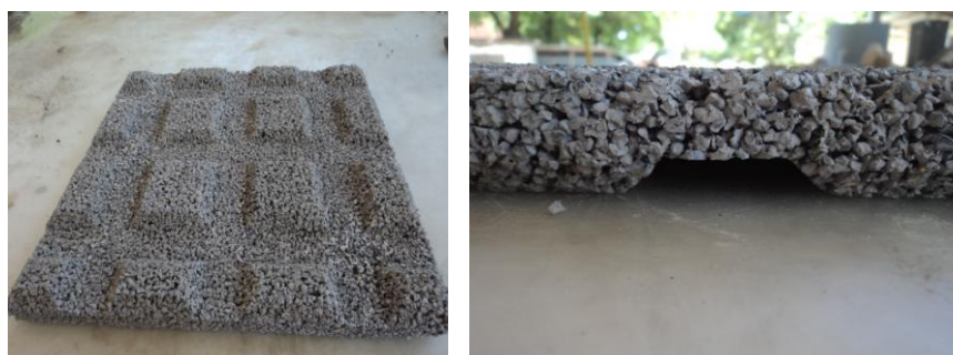
Figura 31 - Placa EVA_ar1 - base com relevo e bolsões de ar de 1 cm de altura Fonte: Acervo pessoal.
