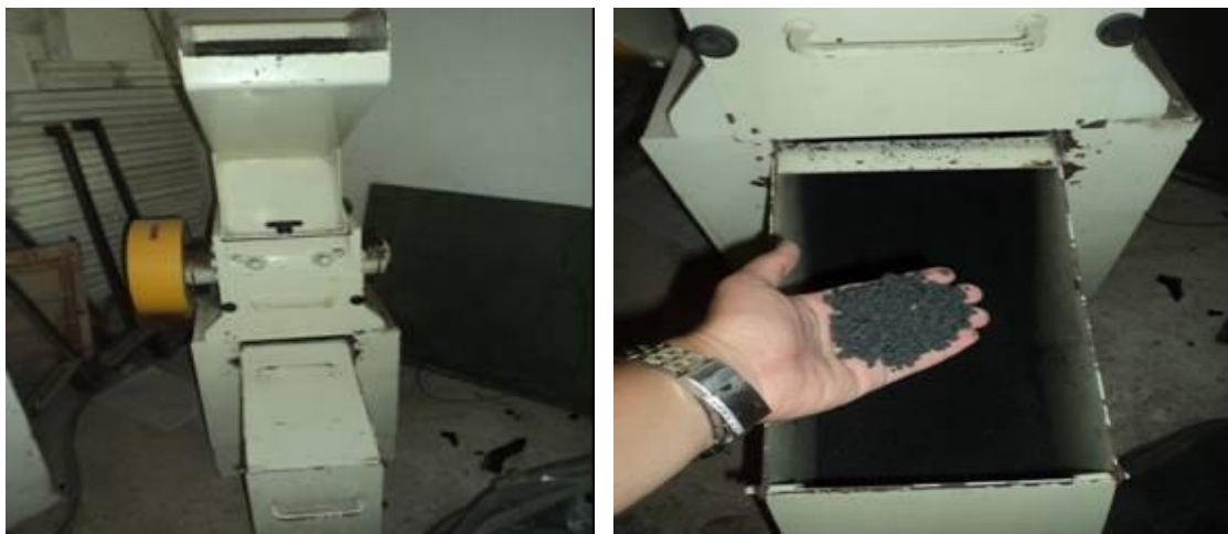
Figura 22 – Moinho de facas rotativas e agregados de EVA com diâmetro máximo característico igual a 4,8 mm
