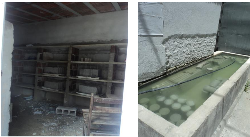
Figura 29 – Câmara úmida e tanque Fonte: Acervo pessoal.
