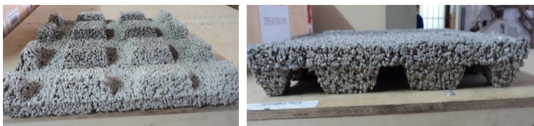
Figura 32 - Placa EVA_ar2,5 – base com relevo e com bolsões de ar de 2,5 cm Fonte: Acervo pessoal.
