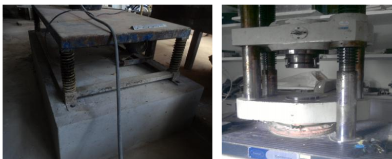
Figura 27 – Mesa vibratória e prensa hidráulica. Fonte: Acervo pessoal.
