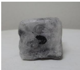
Figura 26 – Cubo impermeabilizado com parafina. Fonte: Acervo pessoal.
