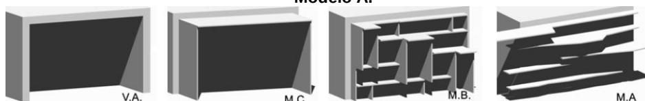
Figura 1.12 - Esquemas de proteção solar utilizados – Vão Aberto, Modelo Comum, Modelo Base e Modelo A.
