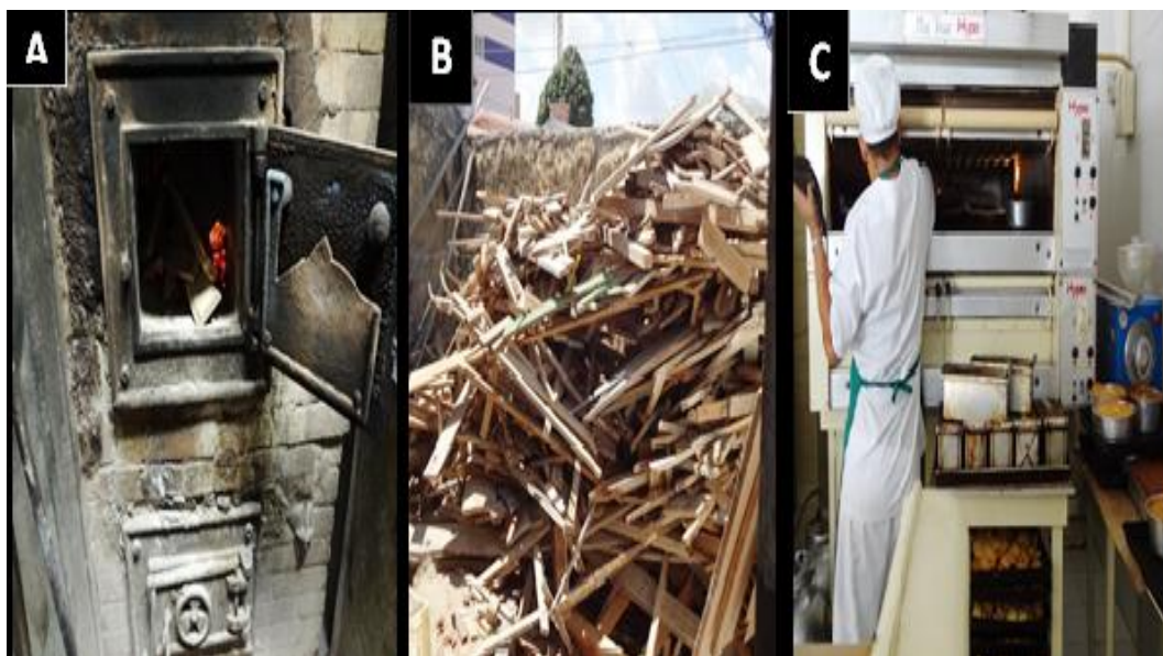
Figura 8. Principais fontes energéticas utilizadas nas panificadoras de João Pessoa. A) Forno a lenha, B) Madeiras restos de construção, C) Forno elétrico. Fonte: próprio autor, 2013.
