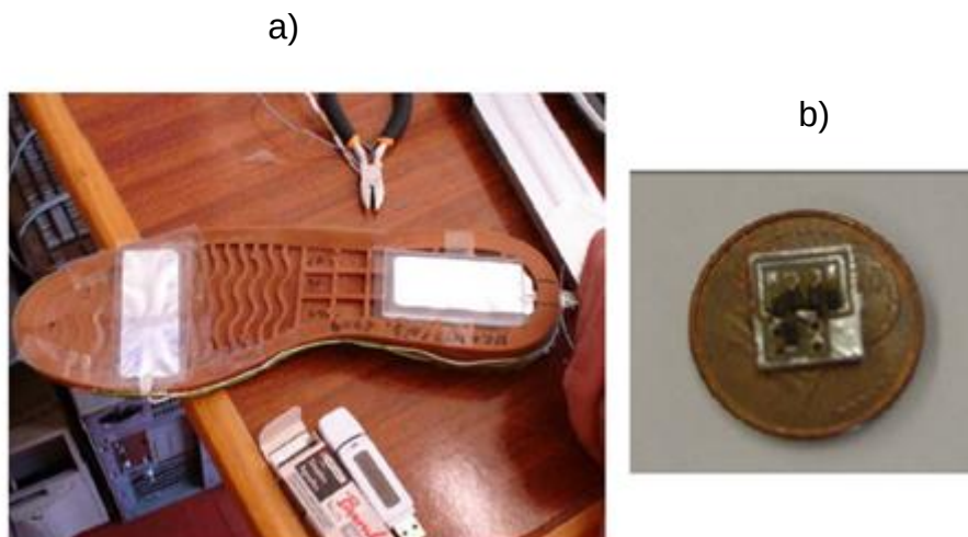
Figura 2.18 – Gerador proposto: a) dois filmes do polímero acima do solado; b) Circuito implementado para o protótipo final (ROCHA et al. 2010)
