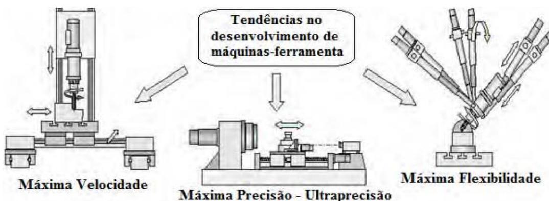
Figura 2.1. Tendências do projeto das máquinas-ferramenta, adaptado de (STOETERAU, 2004).
