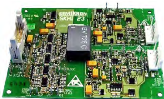
Figura A.4 – Foto do driver SKHI 23/12 (R) da Semikron TM .
