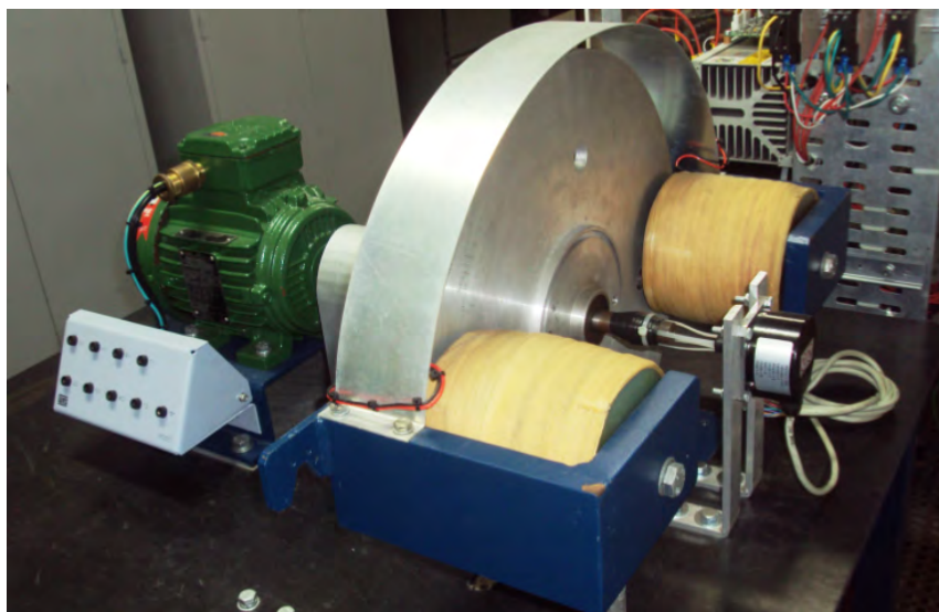
Figura A.5 – Bancada com motor de indução acoplado ao freio.
