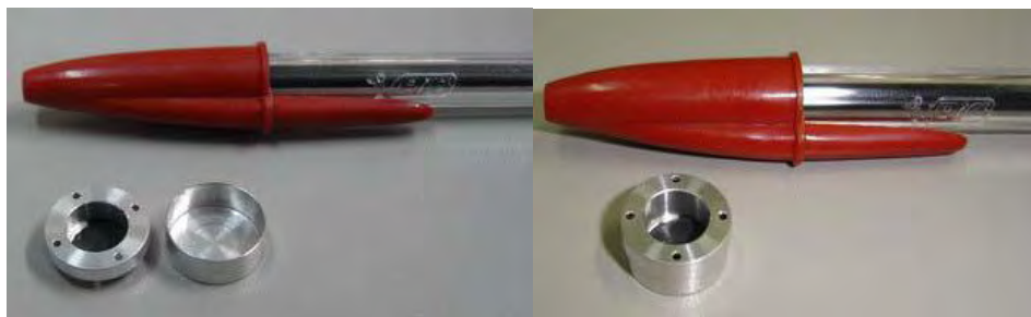
Fig. 5.4 Cápsula para a determinação das propriedades termofísicas de líquidos
