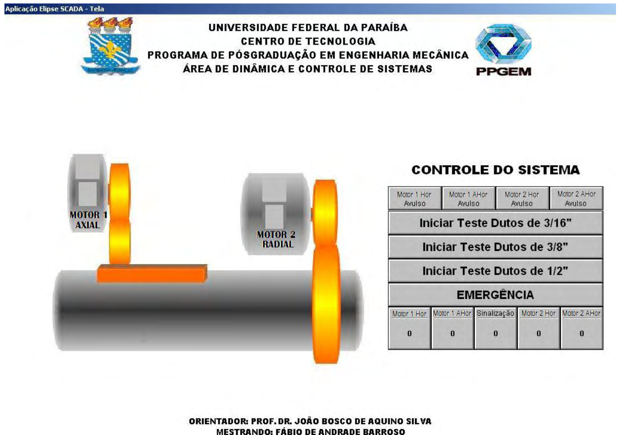
Figura 5.13 – Tela de aplicação final do supervisorio, software utilizado: Elipse SCADA.
