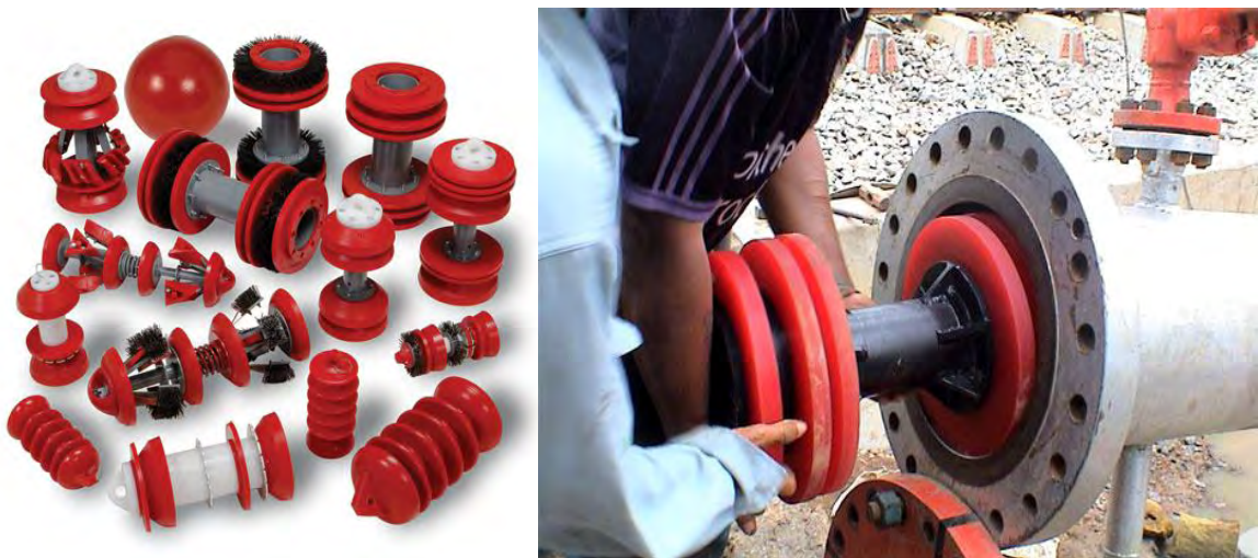
Figura 2.2 – Diversas formas de pig e um operador introduzindo o pig para iniciar a limpeza do duto. Fonte: www.tdwilliamson.com .
