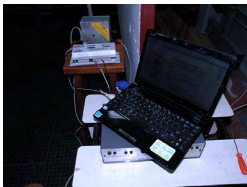
Figura 3.8 – Sistema de aquisição e laptop utilizados nas medições.
