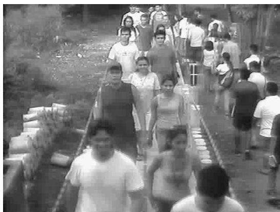
Figura 6.6 – Momento de medição de vibrações da passarela submetida à carga de multidão. (FERNANDES,2007)
