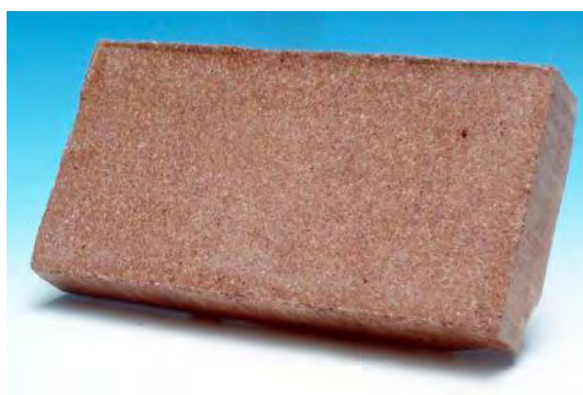
Figura 2.22 – Tijolo de L.T.G.S. produzido com argilas cauliníticas (DAVIDOVITS, 2002)
