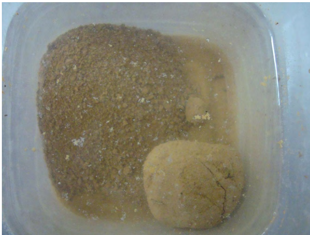
Figura I – Comparação entre uma pelota feita com solo + resíduo líquido de biodiesel de soja e outra usando apenas água potável.
