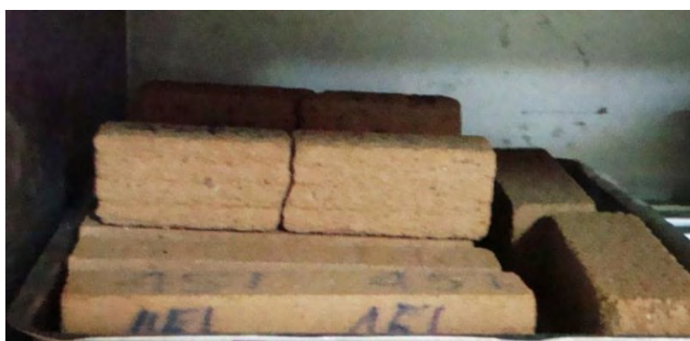
Figura 3.10 - Secagem em estufa a 55°C dos corpos de prova submetidos à secagem.
