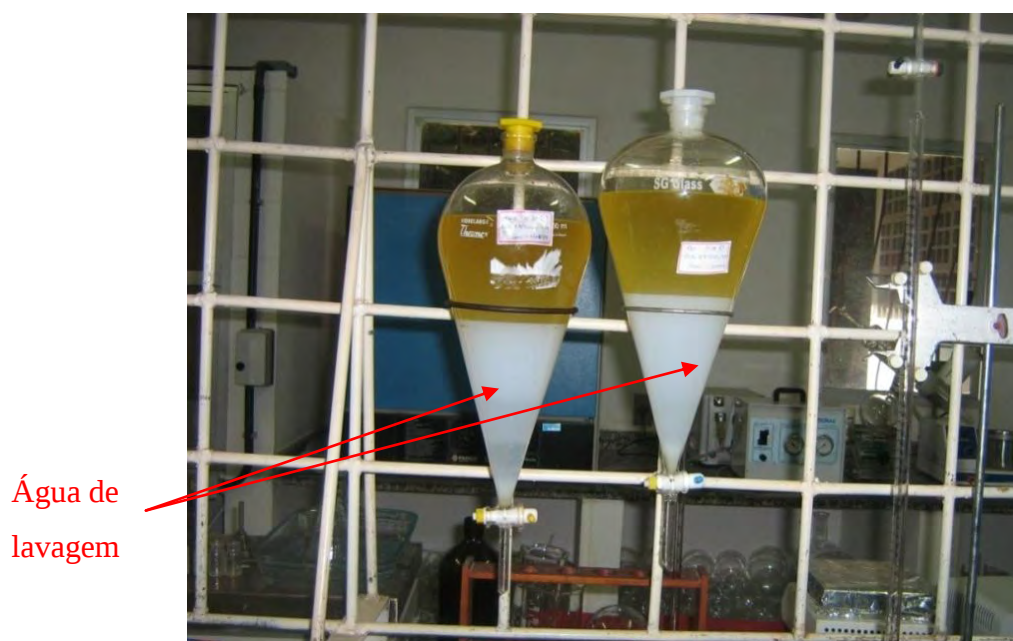
Figura 2.13 - Lavagem do biodiesel em escala laboratorial. (Fonte: GRANGEIRO, 2009).
