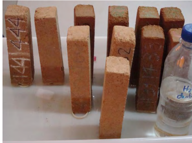
Figura 3.7 – Ensaio de capilaridade.
