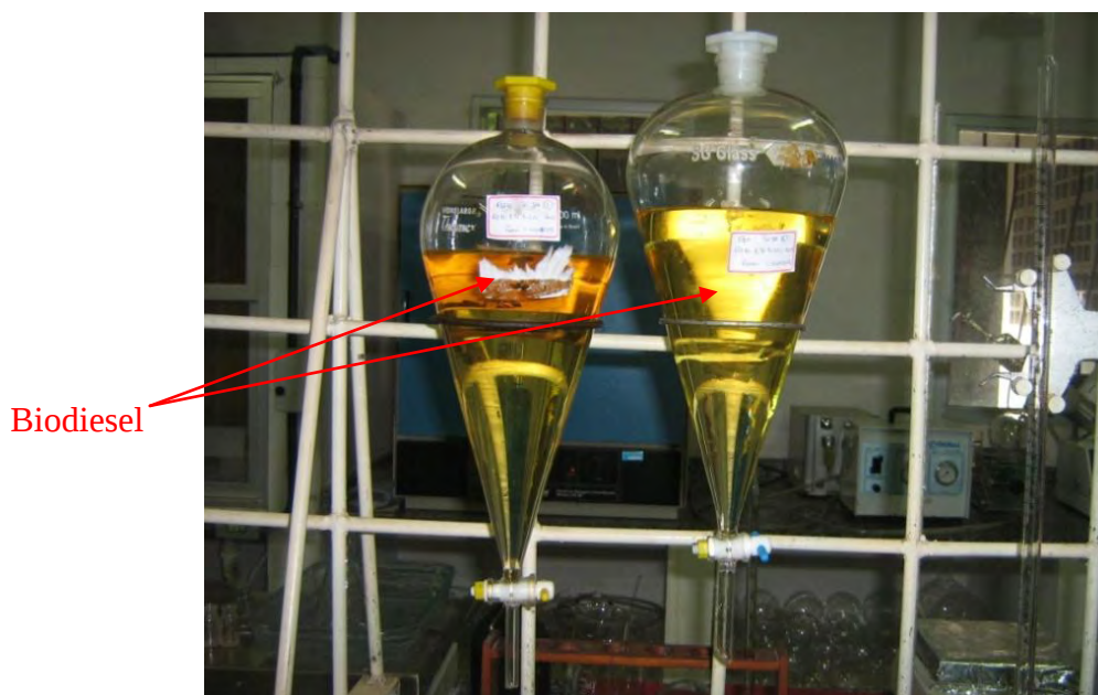
Figura 2.12 - Biodiesel etílico após a retirada da glicerina. (Fonte: GRANGEIRO, 2009).
