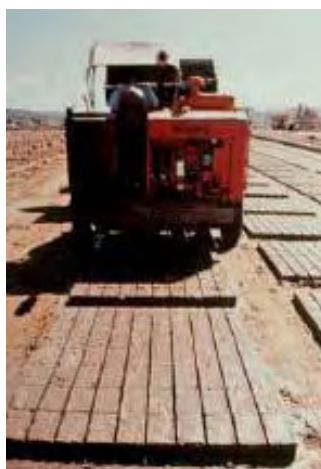
Figura 2.18 – Produção de adobes mecanizados (DETHIER, 1982).
