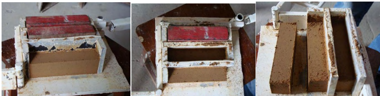
Figura 3.5 – Retirada das amostras dos moldes prismáticos
