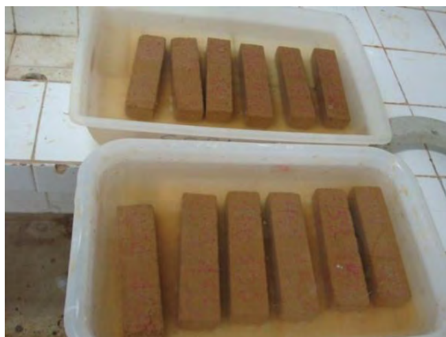
Figura 3.9 - Ciclo de molhagem dos corpos de prova no ensaio de durabilidade
