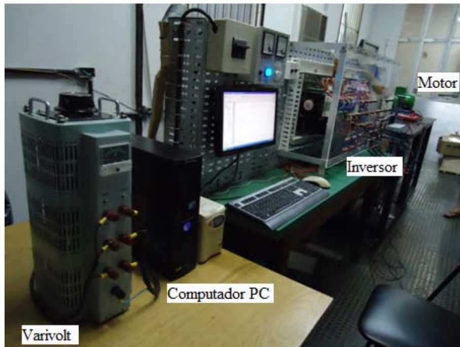
Figura 5.5 Vista panorâmica do protótipo para acionamento de motor de indução
