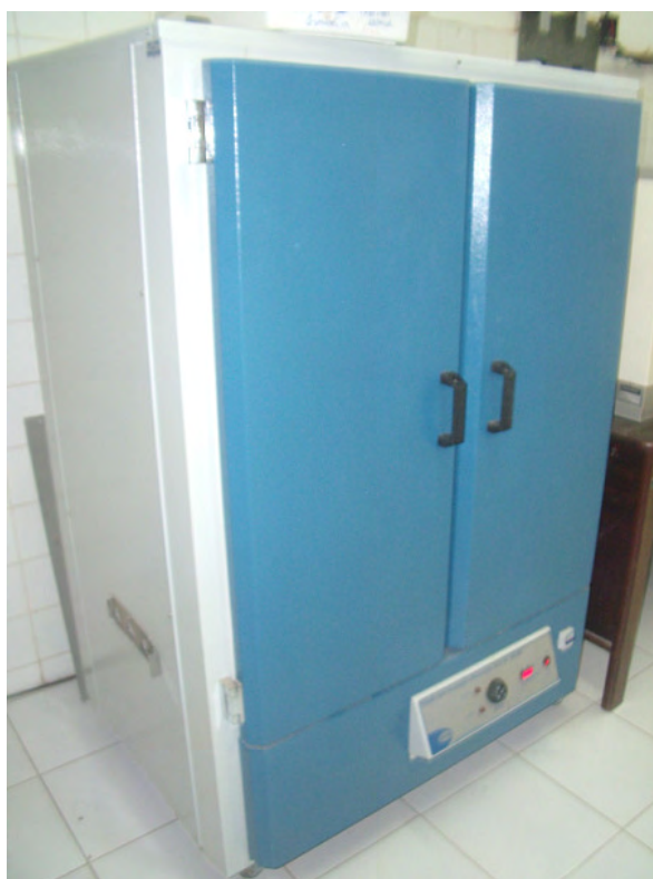
Figura 3.5 - Estufa utilizada para cura do geopolímero após o recobrimento do tubo de aço.
