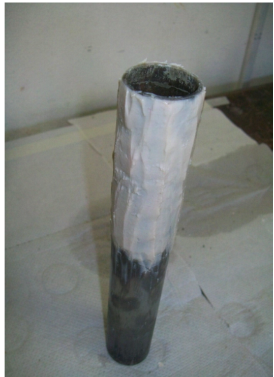
Figura 3.6 - Tubo revestido por geopolímero antes da cura.
