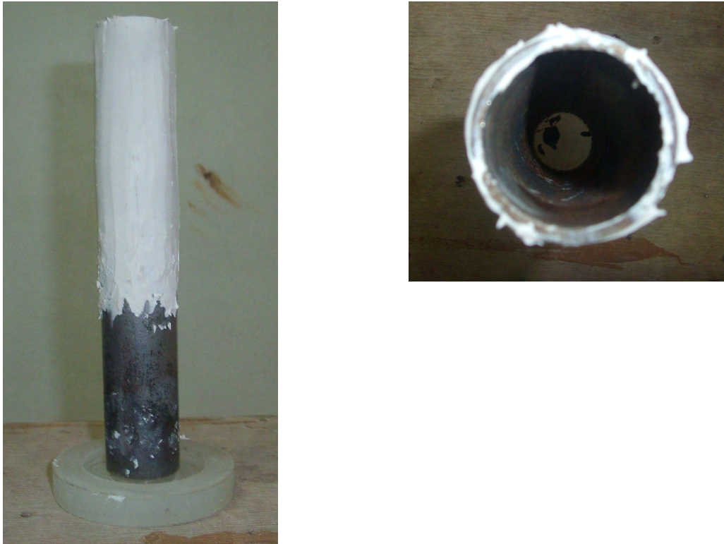
Figura 3.7 - Tubo revestido por geopolímero após a cura.
