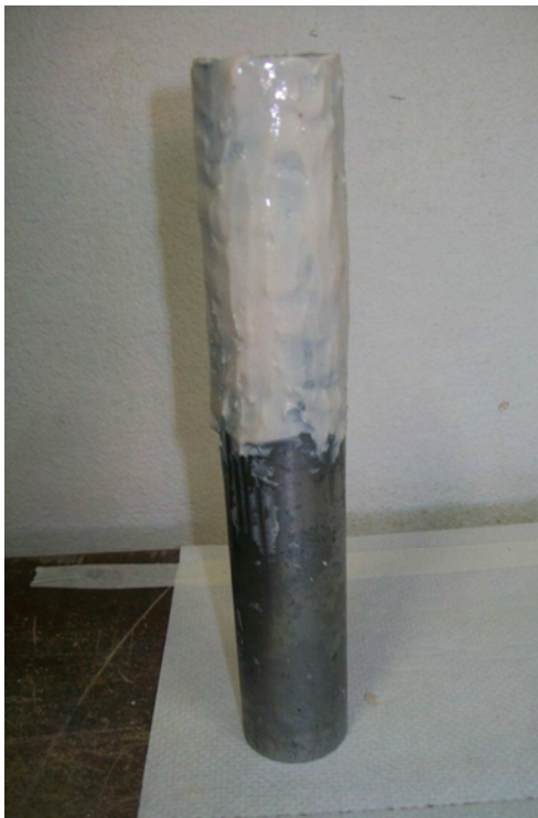
Figura 3.6 - Tubo revestido por geopolímero antes da cura.
