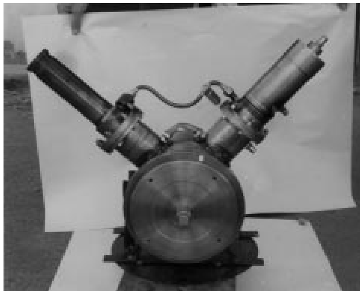
Figura (2.2) - Motor Stirling tipo alfa fabricado por Karabulut (1998)
