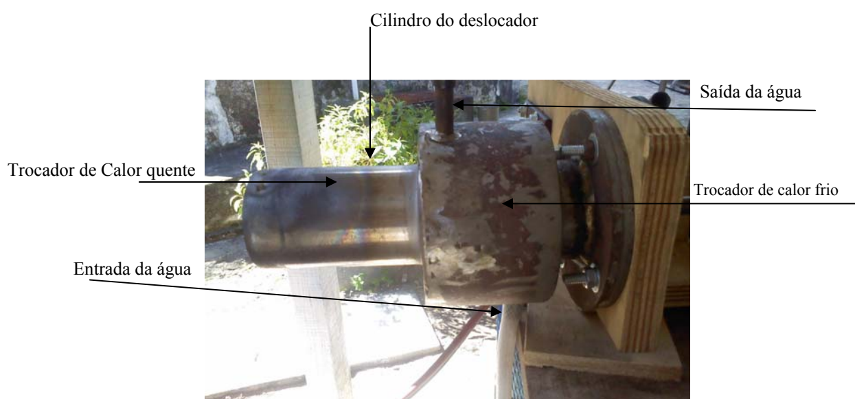
Figura (3.3) - Cilindro do deslocador com trocadores de calor
