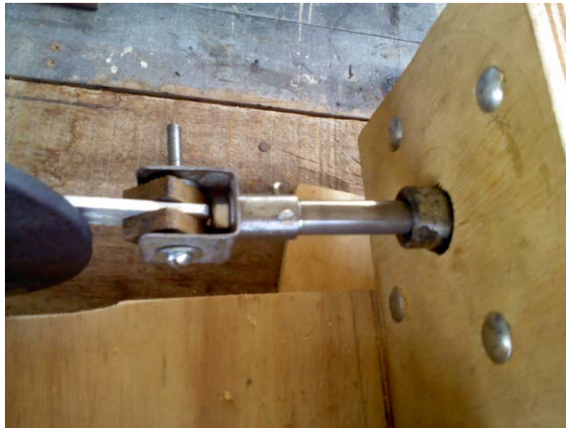
Figura (3.4) - Acoplamento do virabrequim ao pistão deslocador
