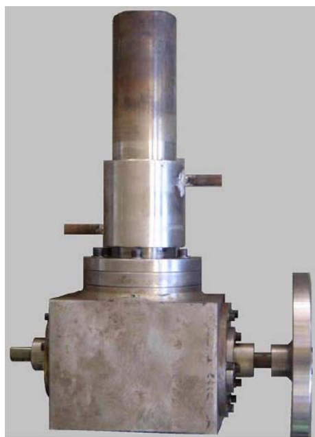
Figura (2.14) Motor Stirling tipo beta desenvolvido por Cinar et al. (2005)
