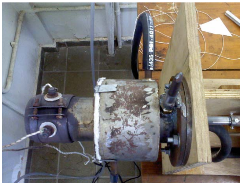
Figura (3.10) - Posicionamento da resistência elétrica no trocador de calor
