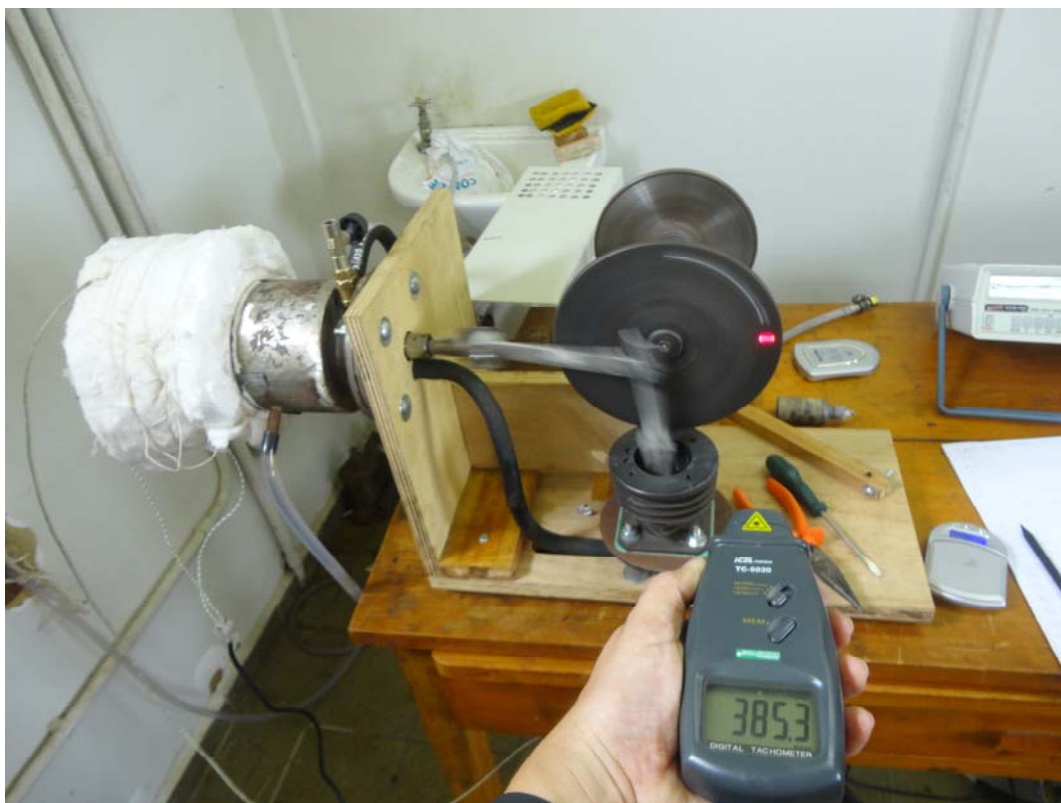
Figura (3.8) Montagem do motor Stirling com os dois pistões acoplados ao mesmo pino
