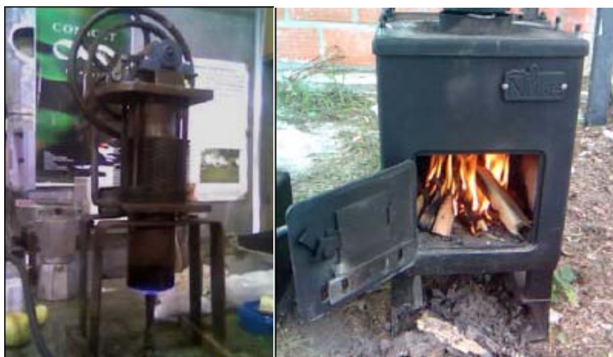
Figura (2.13) – Fornalha (direita) e chama (esquerda) utilizadas nos testes com biomassa e com gás, respectivamente (MANRIQUE et al., 2009)
