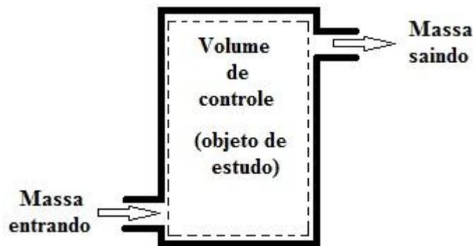
**Figura 3.3** - Diagrama de um volume de controle para a análise da equação da continuidade.
