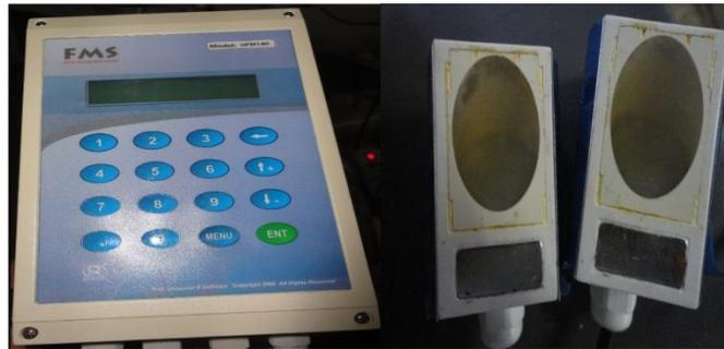
**Figura 5.27** – Medidor de vazão ultrassônico.
