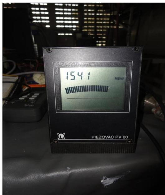
**Figura 5.24** – Medidor de Pressão PIEZOVAC.
