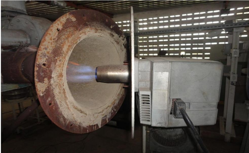
**Figura 5.12** – Queimador em funcionamento.
