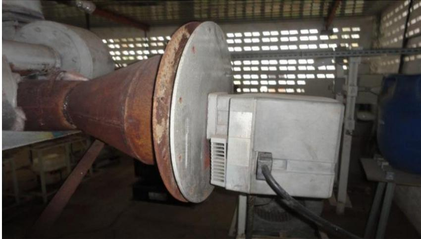
**Figura 5.10** – Túnel de combustão e o queimador.
