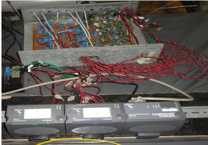
**Figura 5.15** – Fieldpoint e circuito de condicionamento de sinais de temperatura.
