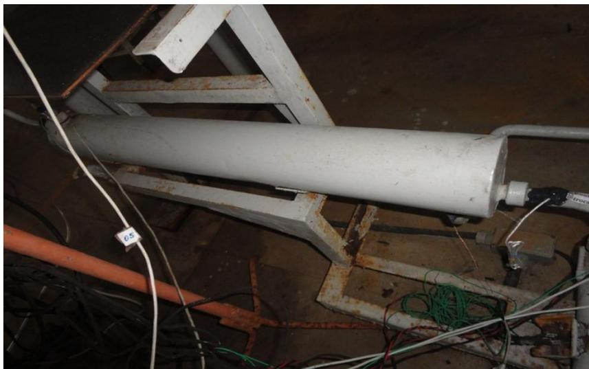
**Figura 5.3** – Trocador de calor de solução da unidade.
