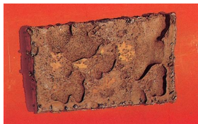
Figura 2.5 - Corrosão em placas em chapa de aço-carbono de costado de tanque (GENTIL, 2011).
