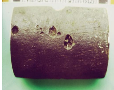
Figura 2.6 - Corrosão alveolar em tubo de aço-carbono (GENTIL, 2011).
