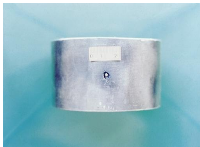
Figura 2.7 - Corrosão por pite em tubo de aço inoxidável (GENTIL, 2011).
