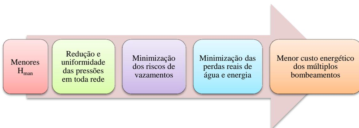
Figura 5.1 - Conclusões sobre o dimensionamento com múltiplos bombeamentos
