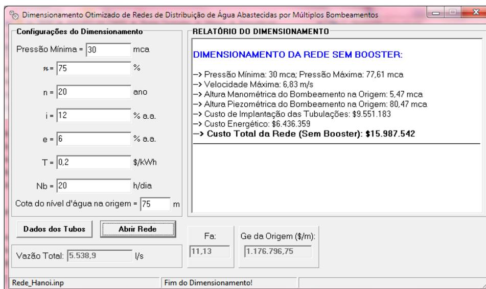
Figura 4.69 - Rede Hanoi dimensionada com bombeamento na origem
