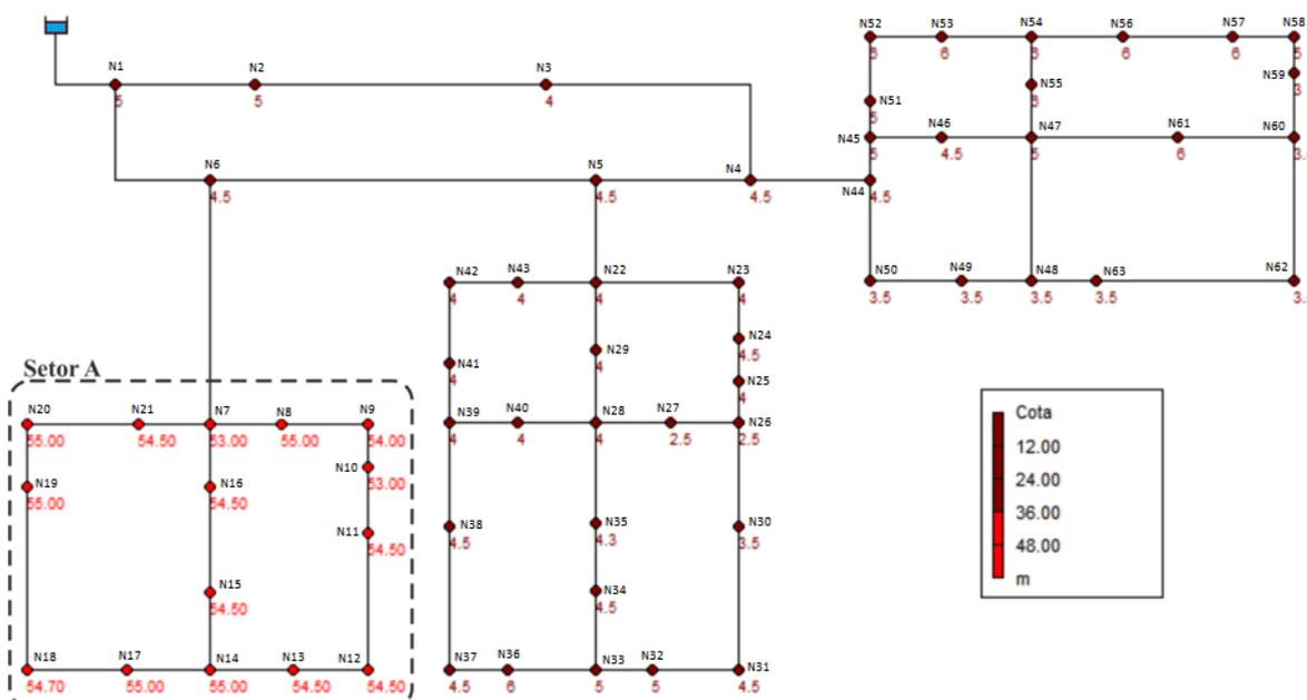
A Figura 4.41 apresenta o resultado do dimensionamento da rede R9 com zona alta no Setor A. A rede R9 com *booster* a montante do setor A foi 23,1% mais eficiente se comparada à mesma rede sem *booster*, proporcionando uma economia de \$2.509.207,50. Na rede sem *booster*, o custo de implantação das tubulações da rede foi menor, entretanto, o custo energético foi 45,72% menor na rede com *booster*, o que justifica a economia de 23,1% no custo total.
