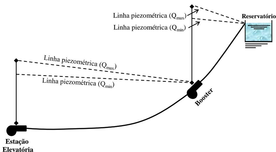
Figura 2.12 - Booster para reforço no bombeamento
