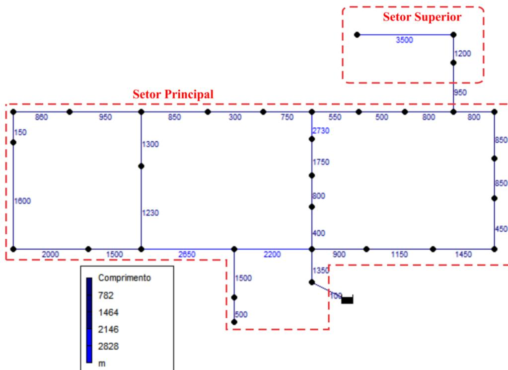
Figura 4.71 - Esquema da rede Hanoi setorizada
