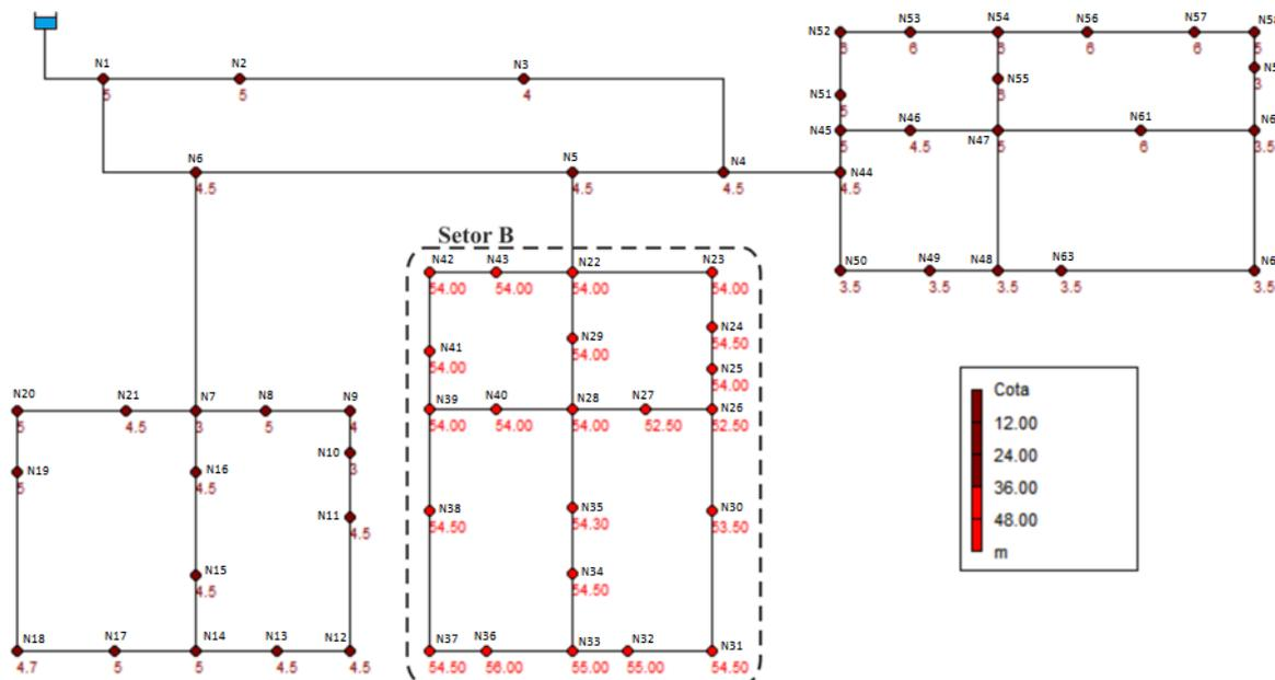
Figura 4.47 - Esquema da rede R9 com zona alta no Setor B
