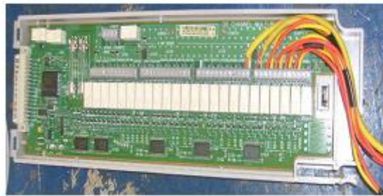
Figura 4. 15 - Placa de entrada para conexão dos cabos de extensão dos sensores.
