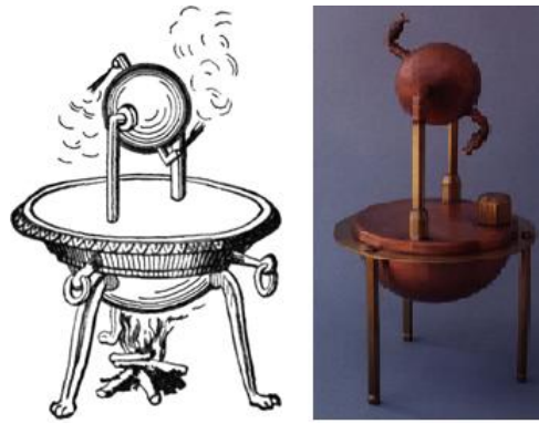
Figura 2. 6 - Motor de Heron
