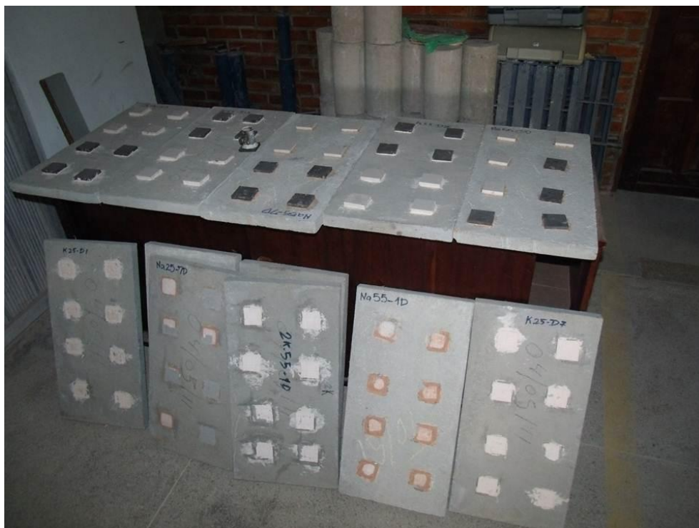
Figura 6.2: Porcelanatos Branco e Preto antes (superior) após ensaio da ABNT (inferior).
