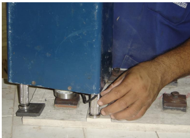
Figura 3.8: Ensaio de Arrancamento sendo realizado.
