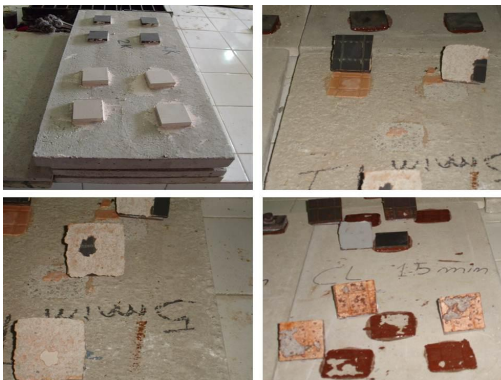
Figura 6.3: Porcelanatos colados com adesivo geopolimérico antes (superior esquerdo) e após ensaio da ABNT (superior direito e inferior esquerdo e direito).
