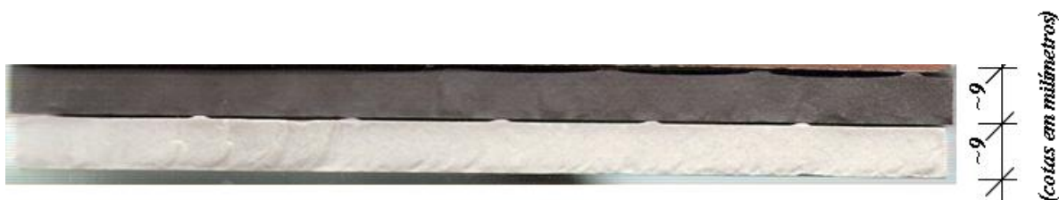
Figura 3.5: Detalhe lateral das peças cerâmicas: Porcelanato Branco (inferior) e Porcelanato preto (superior).
