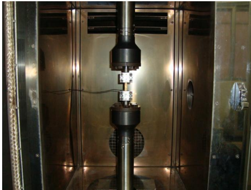
Figura 3.2: Máquina de tração estática e dinâmica Servo Pulser EHF da Shimadzu.
