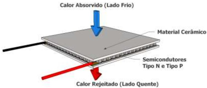
Figura 5.9 Ilustração do Módulo Termoelétrico
