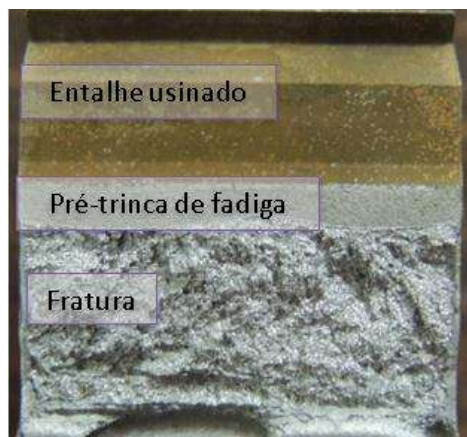
Figura 3.21a – Regiões do corpo de prova SE(B) fraturado
