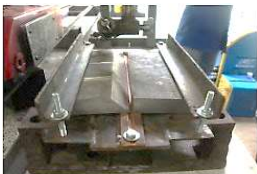
Figura 3.11a – Fixação das chapas antes da soldagem
