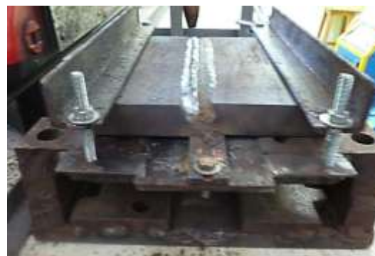
Figura 3.11b – Processo de soldagem finalizado
