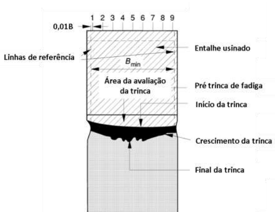
Figura 2.9 – Medição da pré trinca de fadiga do corpo de prova SE (B), ISO 12135 (2002)
