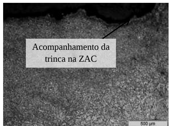
Figura 4.14d – Propagação da trinca na ZAC
