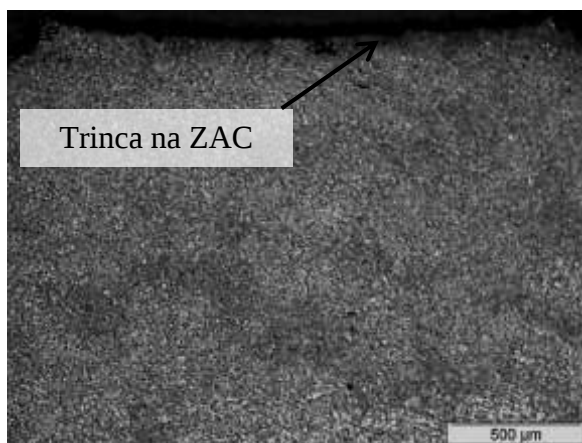
Figura 4.14c – Início da trinca na ZAC
