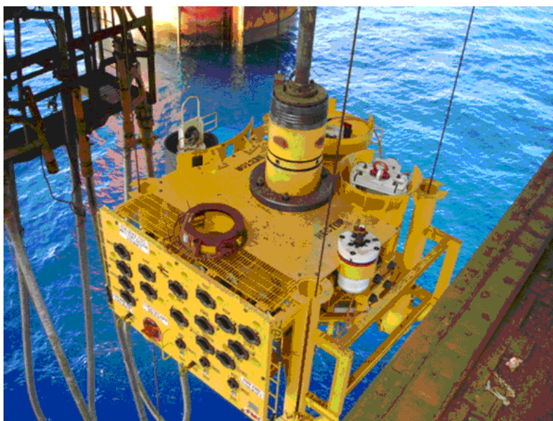
Figura 2.1 – Equipamento árvore de natal horizontal (ANM, 2013)
