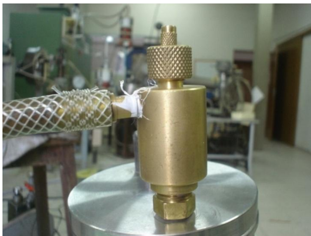
Figura-3.3 Detalhes da câmara de vácuo do sistema usado para controle da atmosfera.
