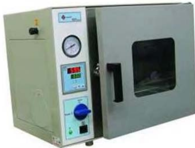
Figura 2.9. Sistema de médio vácuo aplicado em uma estufa
