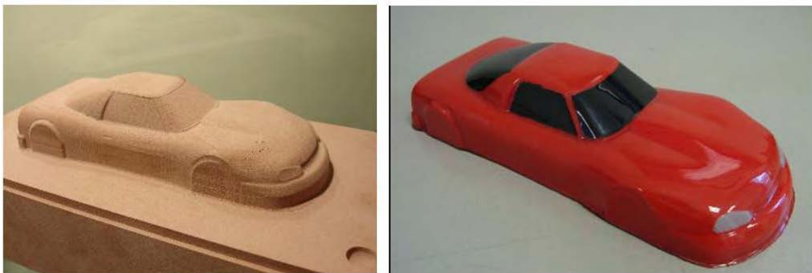
Figura 2.8. Produto final obtido em termoconformação a vácuo
