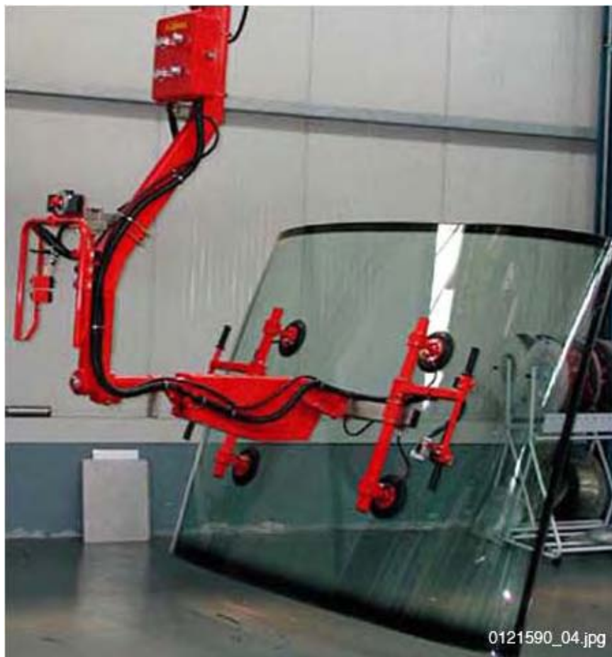
Figura 2.7. Sistema de baixo vácuo utilizado em robô manipulador
