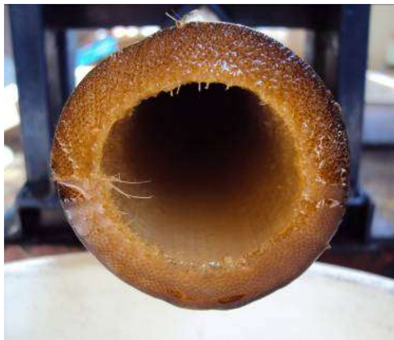
Figura 5.49- Bambu impregnado com a resina.
