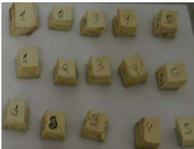
Figura 4.3- Corpos de prova para ensaio de absorção por imersão.
