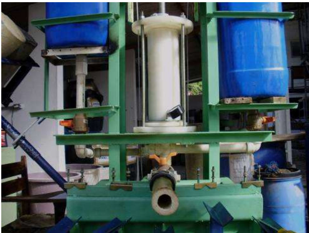
Figura 4.4 – 1ª máquina de impregnação de fluidos no bambu.
