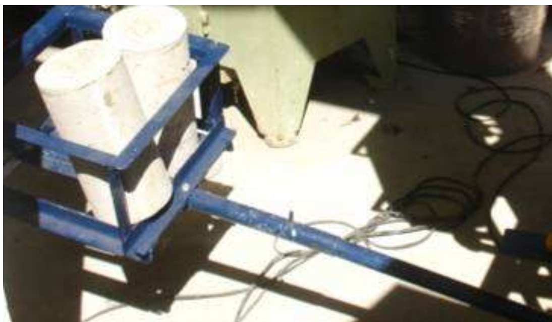
Figura 4.7 – Cesto para aplicação de pressão na máquina.
