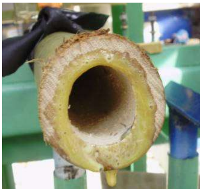
Figura 5.40- Bambu impregnado com o óleo 40 W.
