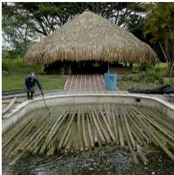
Figura 2.19- Cura do Bambu por Imersão (CONBAM, 2007).
