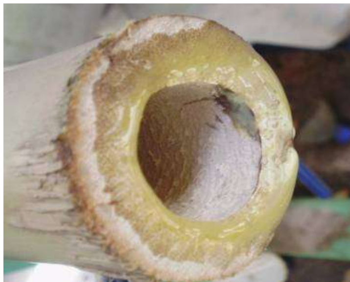
Figura 5.39- Bambu impregnado com o óleo 20 W.
