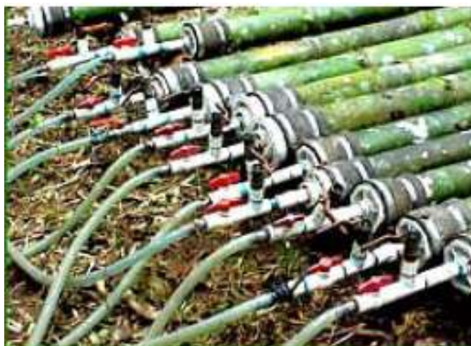
Figura 2.22 - Aplicação do método Boucherie em varas de bambu. (TEIXEIRA, 2006).
