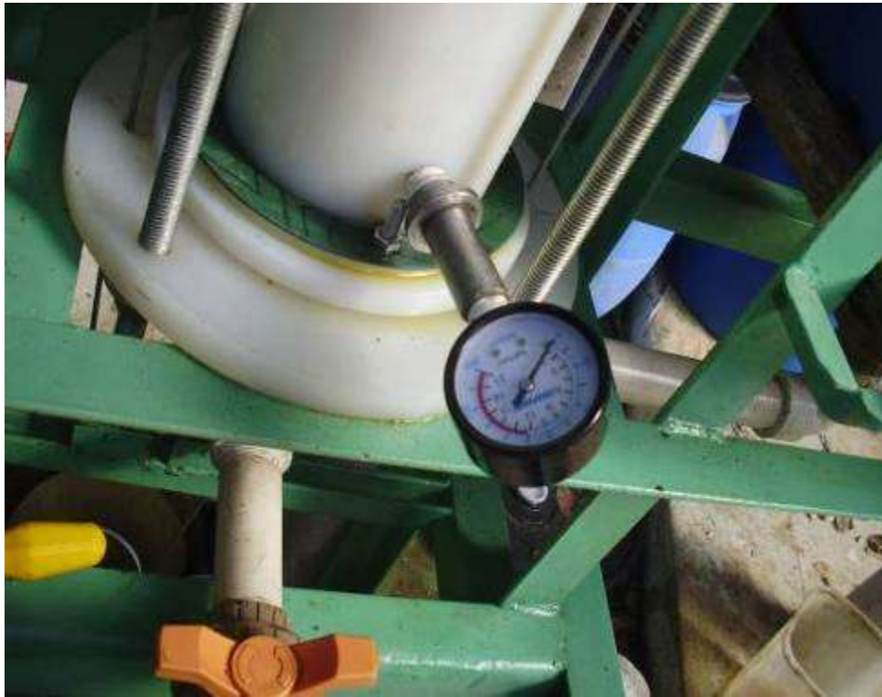
Figura 4.8 – Manômetro situado na parte inferior do cilindro.
