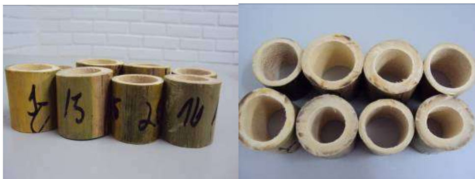
Figura 4.10 – Corpos de prova de bambu para ensaio à compressão.
