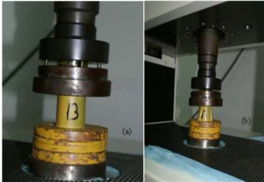
Figura 4.11- Ensaio de resistência à compressão. (a) Início do ensaio e (b) ruptura do corpo de prova.
