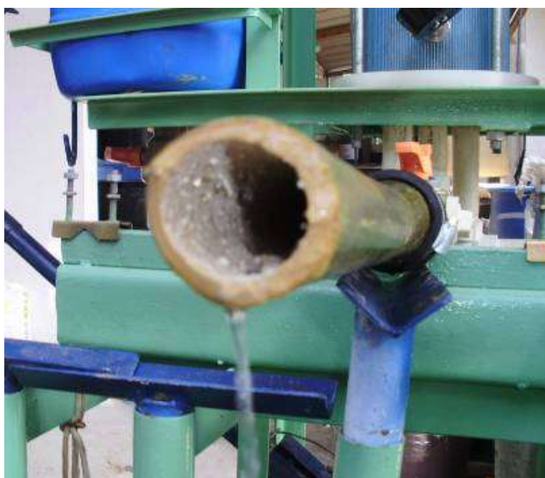
Figura 5.38 – Bambu impregnado com água através dos seus vasos.
