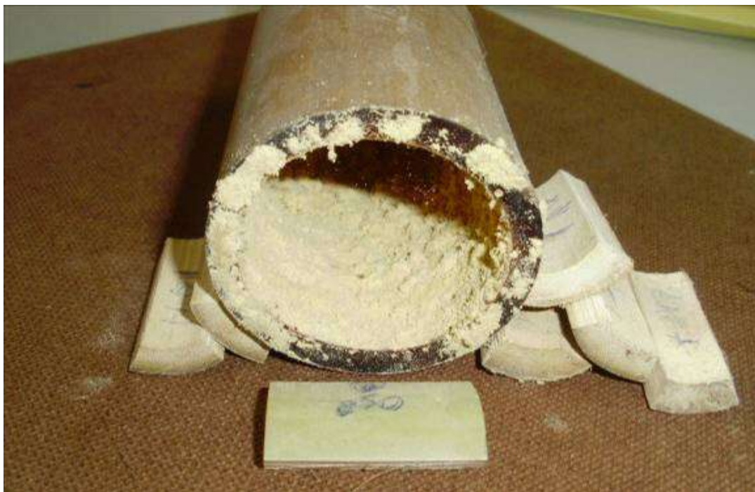
Figura 5.51 – Durabilidade dos bambus in natura e impregnado após 60 dias de corte.
