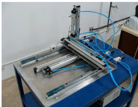
Figura 2.2 – Foto do robô manipulador eletropneumático de três graus de liberdade cartesiano
