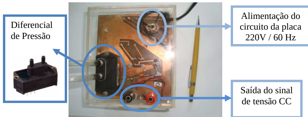
Figura 3.13 - Placa de aquisição de dados para obter o valor do diferencial de pressão do fluxo a gás.
