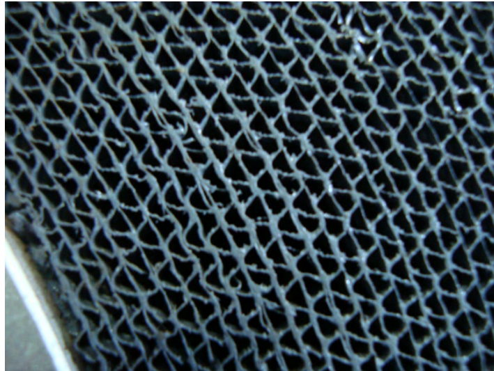
Figura 3.7. Perfil dos canais do rotor dessecante usado neste trabalho.
