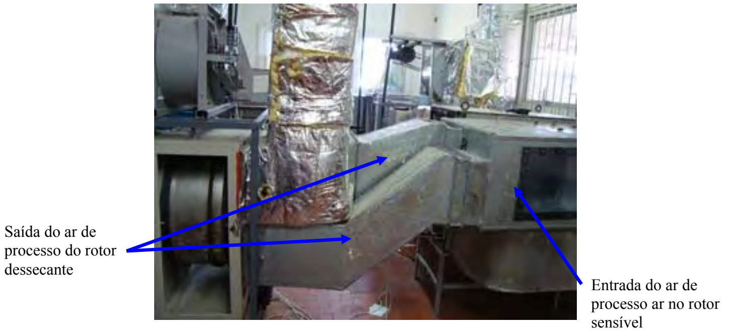
Figura 4.2. Acoplamento das seções dos rotores dessecante e sensível.
