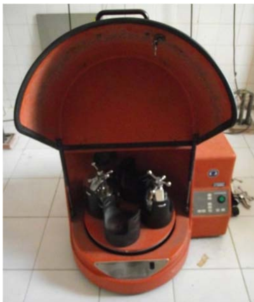
Figura 10 - Moinho de esferas planetário FRITTSCH PULVERISETTE 5
