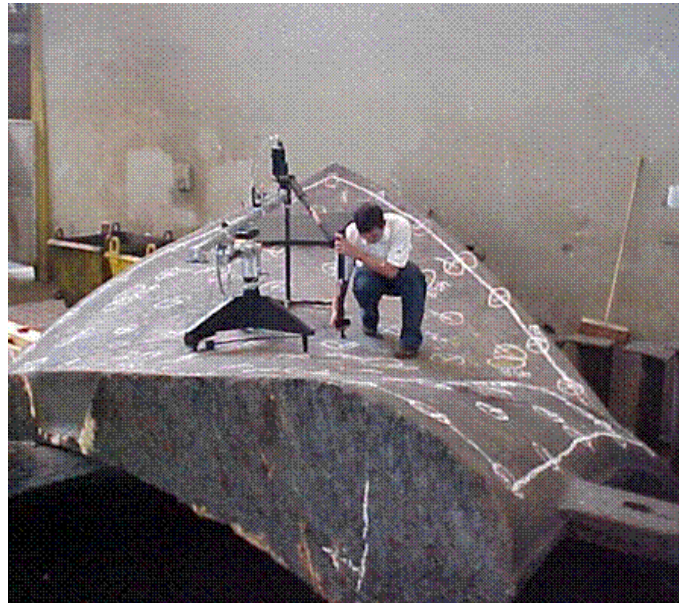
Figura 2.6 - Medição de uma pá de turbina com braço de medição (LIMA, 2006).
