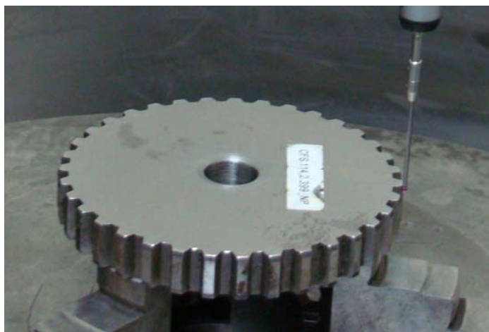
Figura 6.2 – Medição da engrenagem selecionada para o experimento 1
