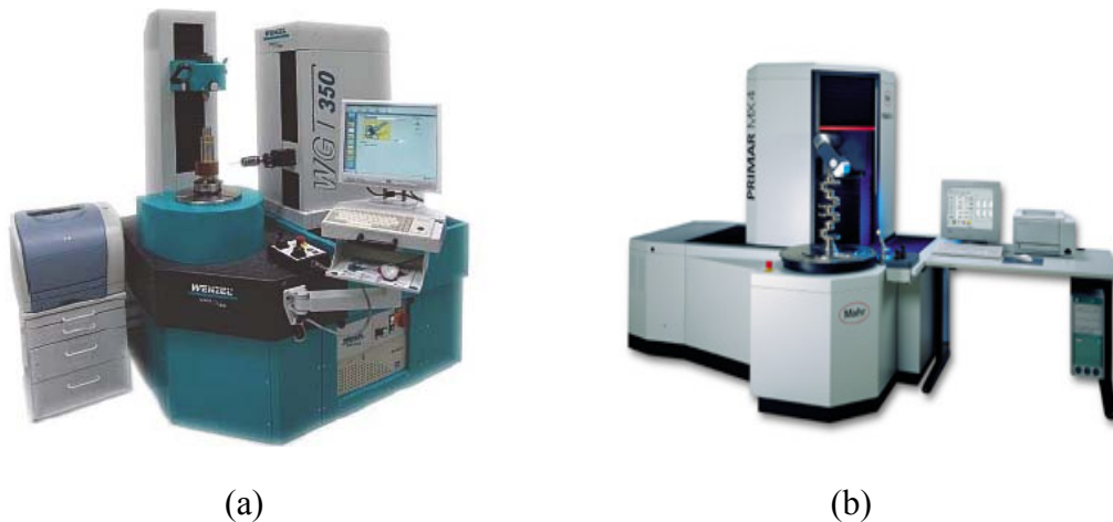
Figura 2.22 - Sistema de medição dedicado (a) e sistema de medição híbrido (b)
