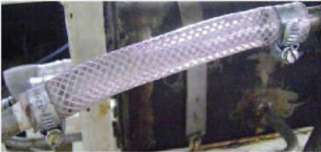
Figura 6.5 – Visor de tubo de vidro revestido com mangueira e fixado através de braçadeiras nas extremidades.
