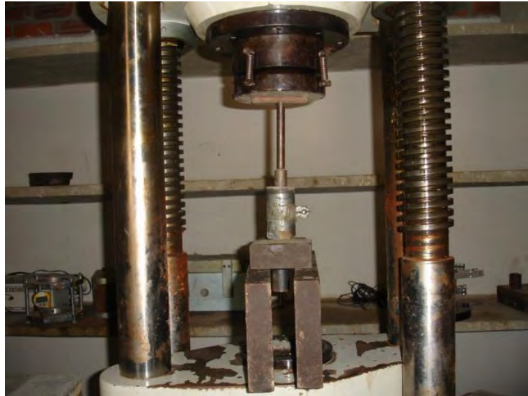
Figura 3.6 Esquema para retirar a casca de cimento.
