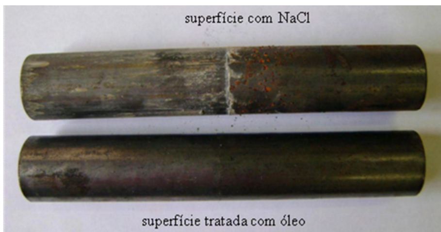
Figura 4.4 Superfície do tubo de aço com condição de contato NaCl e com condição de contato óleo aos sete dias.
