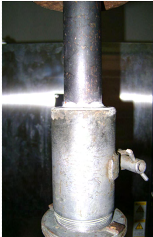
Figura 3.5 Representação do ensaio estático de aderência.
