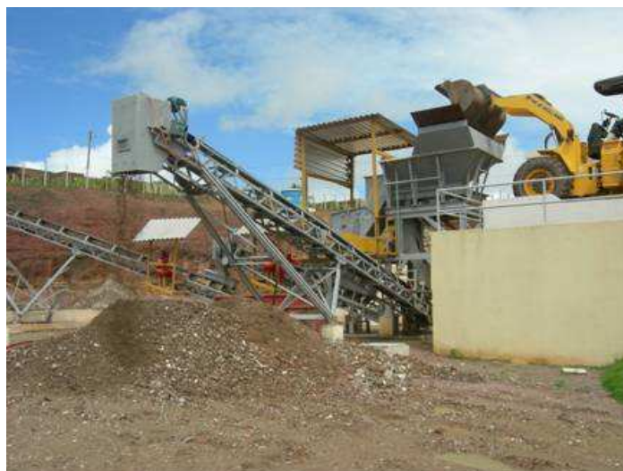
Figura 31 - Beneficiamento de material com composição não concretícia
