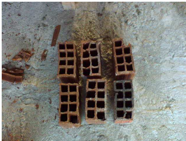
Figura 05 - Qualidade comprometida dos materiais recebidos
