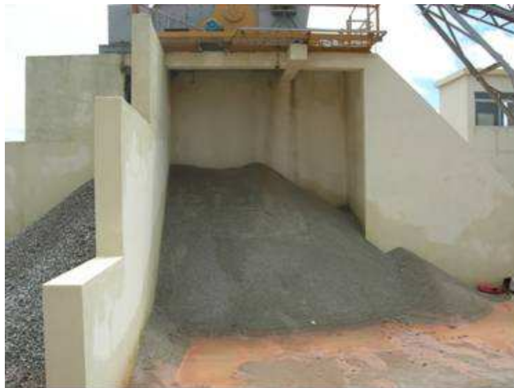
Figura 28 - Baias que separam material beneficiado por diâmetro
