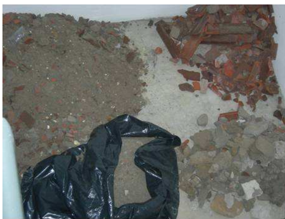
Figura 36 - Resíduos de Construção em Processo de Separação
